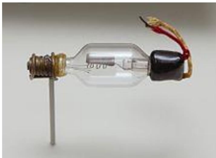
Slika 2.2: Rešetkasti Audion s tri elektrode [2]
