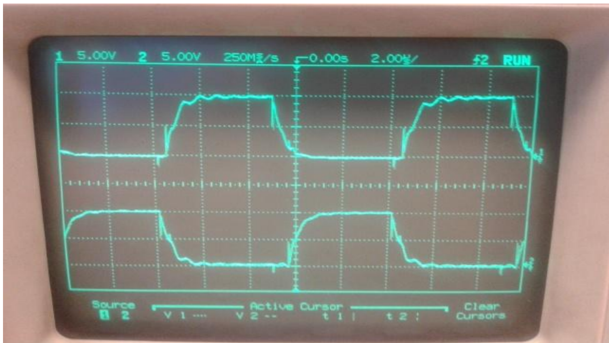
Slika 6.9 Valni oblik upravljačkog napona na upravljačkim elektrodama
