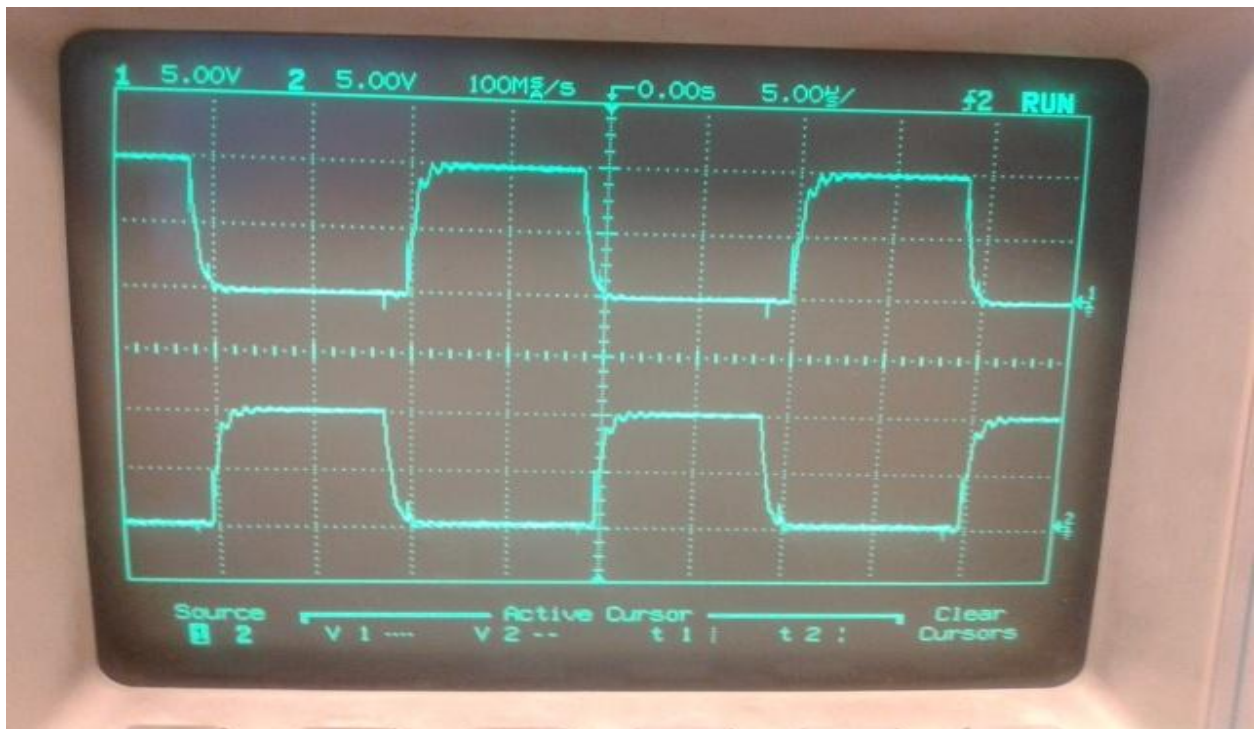
Slika 6.7 Valni oblik upravljačkog napona na upravljačkim elektrodama
