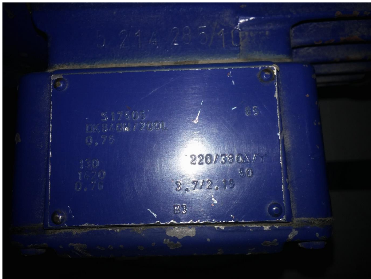
Slika 4.2. Natpisna pločica na motoru krajšera
