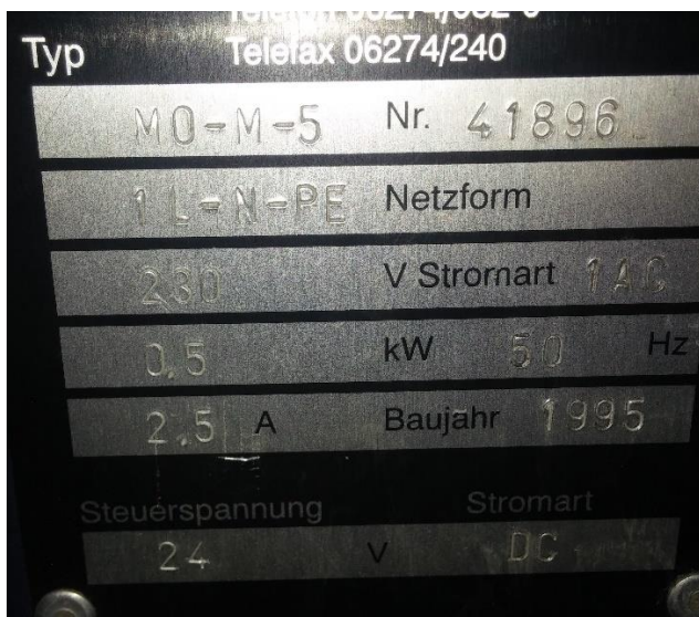
Slika 4.15. Natpisna pločica motora
