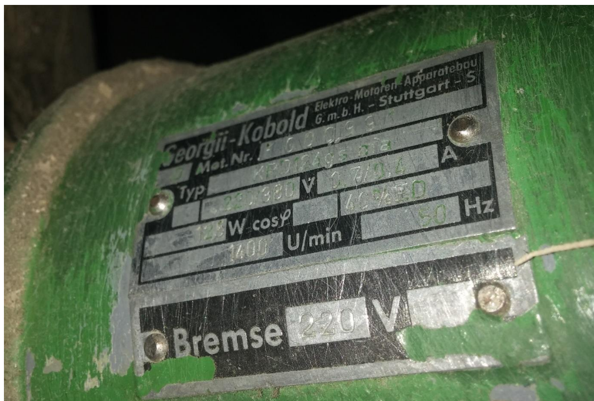
Slika 4.10. Natpisna pločica jednog od motora automatskog slotera
