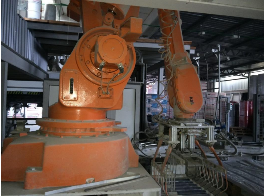
Slika 3.34. Robot za slaganje vreća na palete
