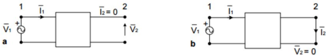
Sl. 2.4. Pokusi za određivanje matrice [\bar{L}] [3]
