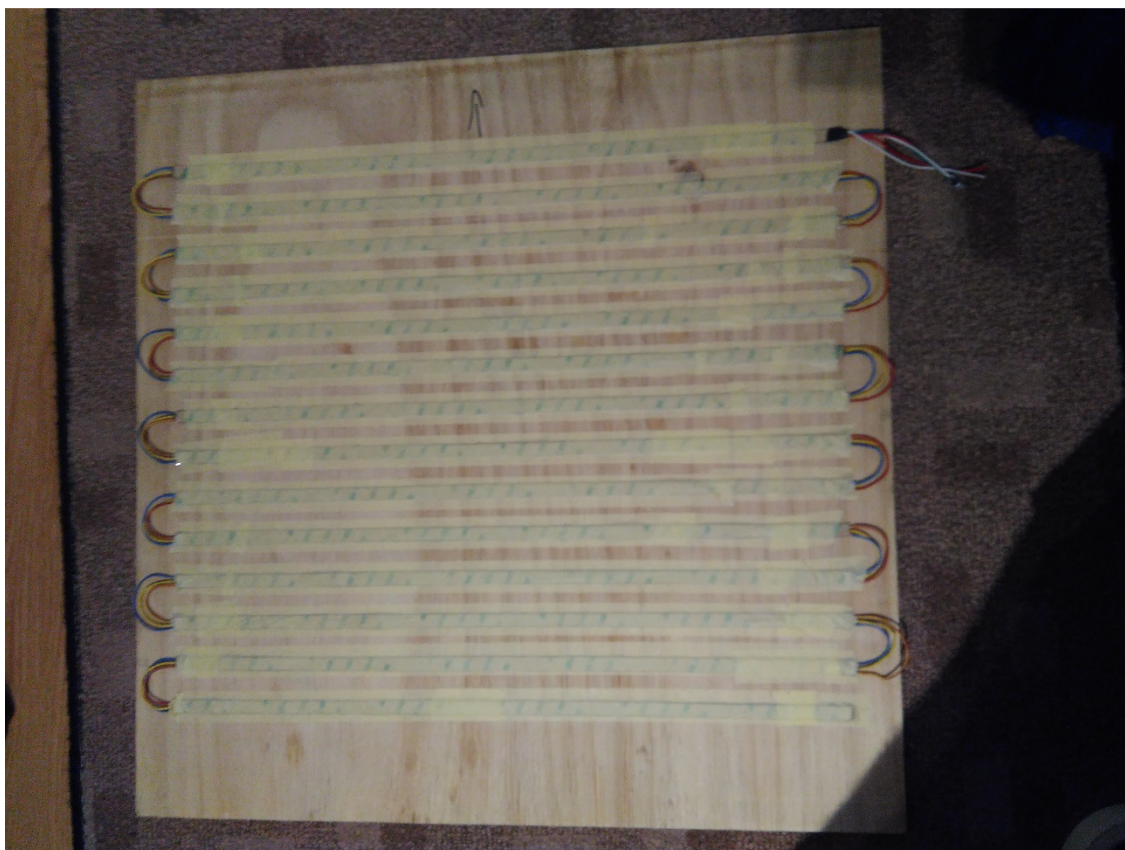
Sl. 3.8 LED-ice pričvrščene ljepljivom trakom
