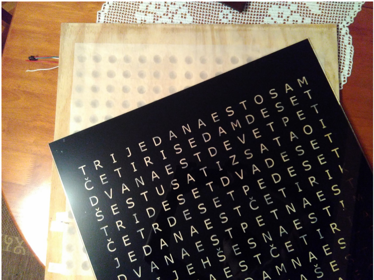
Sl. 3.7 Paus papir i staklo spremno za lijepljenje
