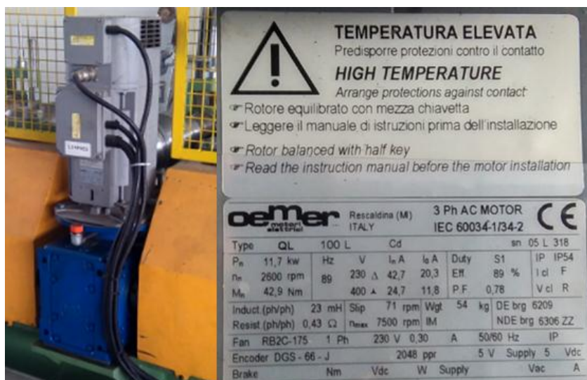
Slika 3.29. Motor s reduktorom za pogon valjaka i kadar uvećane natpisne pločice motora
