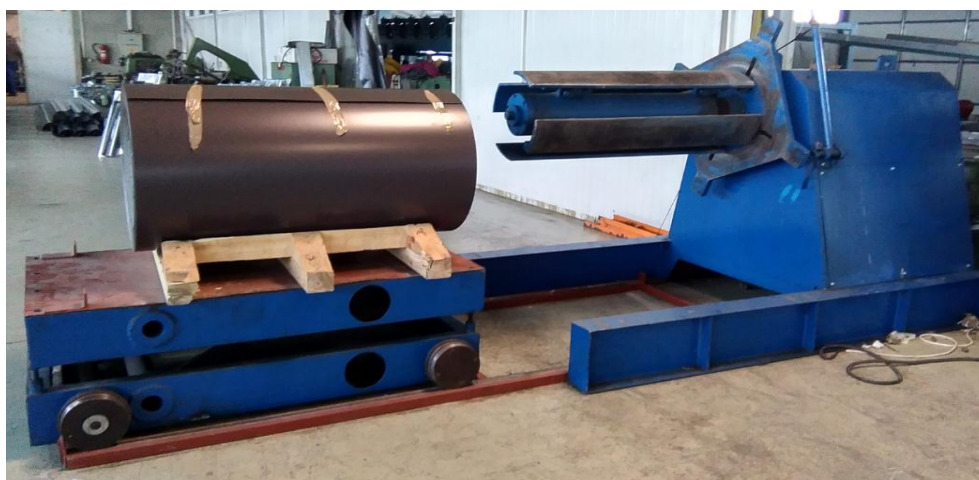
Slika 3.19. Postavljanje role lima na strojna namatalicu
