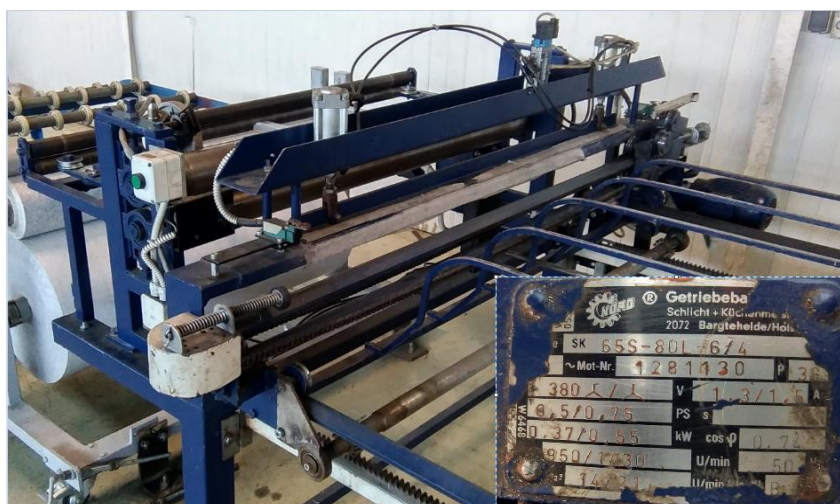
Slika 3.45. Škare T-35 stroja i kadar u kojem je povećana natpisna pločica motora za pogon škara i prednjih vučnih valjaka
