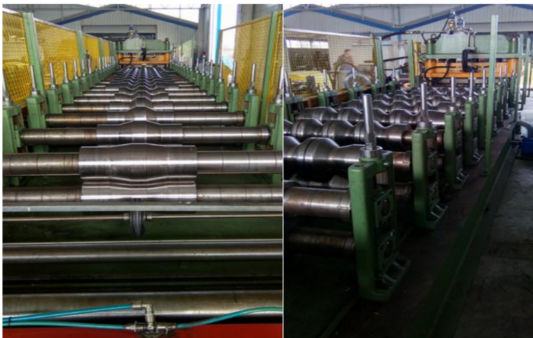
Slika 3.26. Stroj za proizvodnju crijep ploča – valjci za profilaciju
