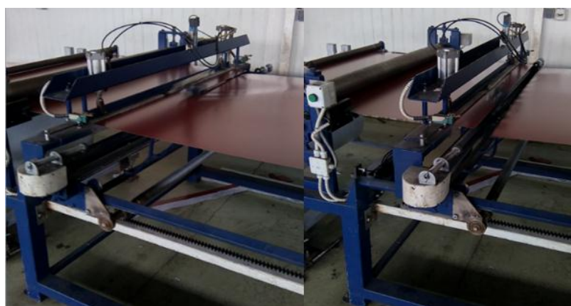
Slika 3.46. Škare T-35 stroja u procesu rezanja lima
