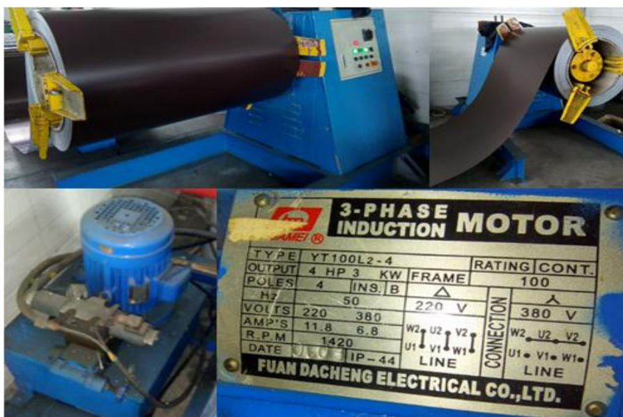
Slika 3.20. Strojna namatalica sa postavljenim limom; kadar s uvećanim motorom i natpisnom pločicom
