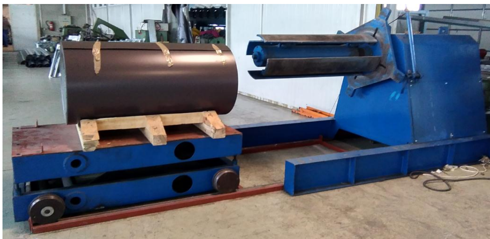
Slika 3.19. Postavljanje role lima na strojna namatalicu
