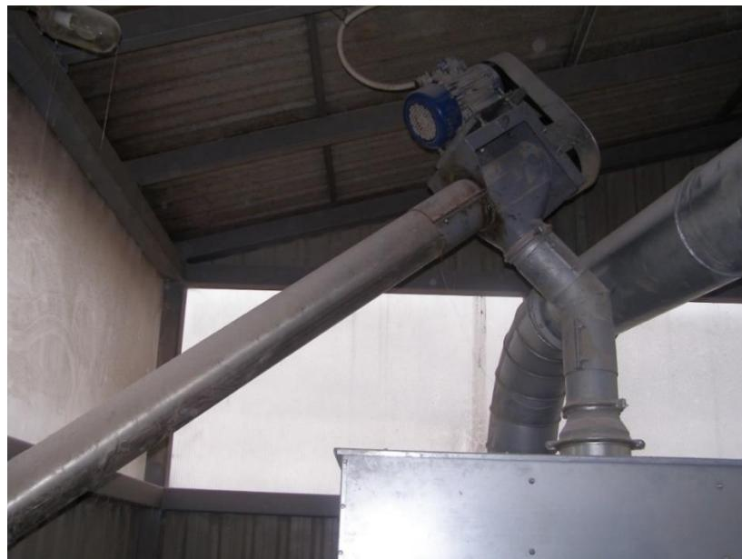
**Slika 4.2.** Pužni transporter s pogonskim motorom
