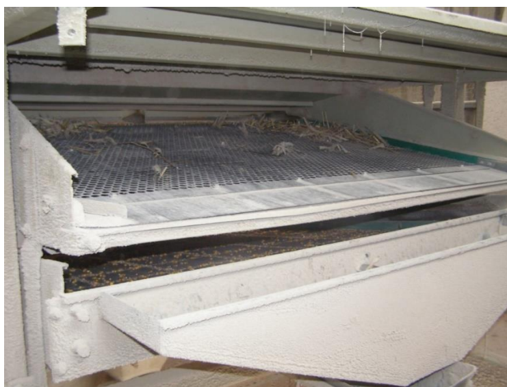
Slika 4.3. Sita prečistača s kanalom za nečistoće
