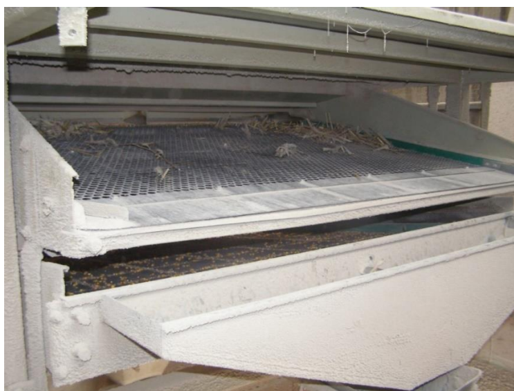
Slika 4.3. Sita prečistača s kanalom za nečistoće
