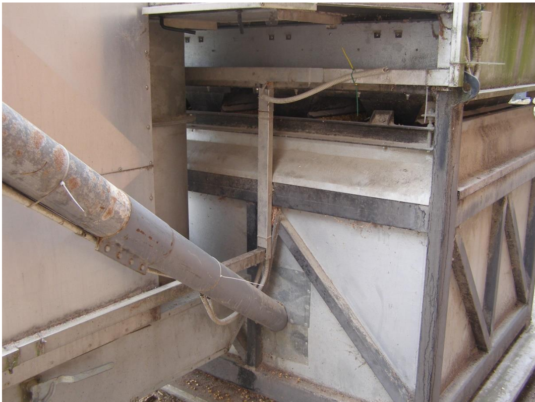
Slika 5.10. Spremnik za zrno ispod izuzimača
