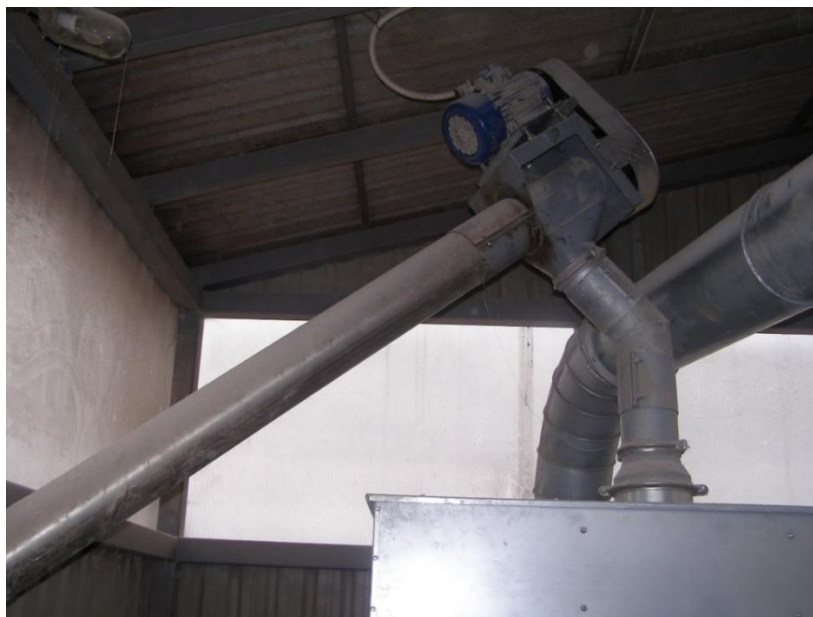
Slika 4.2. Pužni transporter s pogonskim motorom
