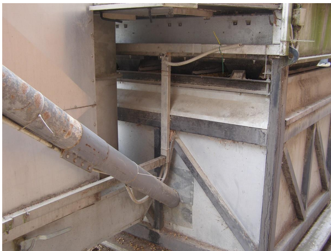
Slika 5.10. Spremnik za zrno ispod izuzimača
