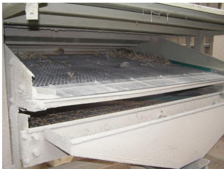
**Slika 4.3.** Sita prečistača s kanalom za nečistoće
