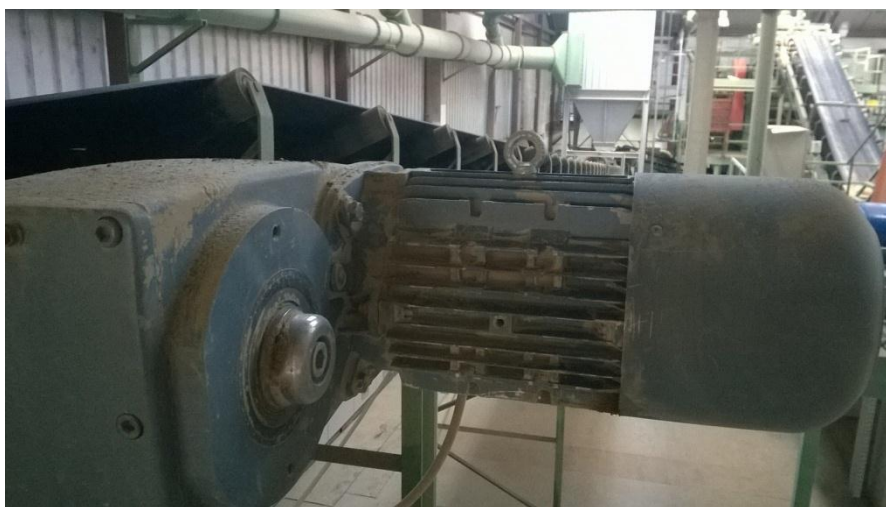
Slika 4.3. Transportna traka za prijevoz gline
