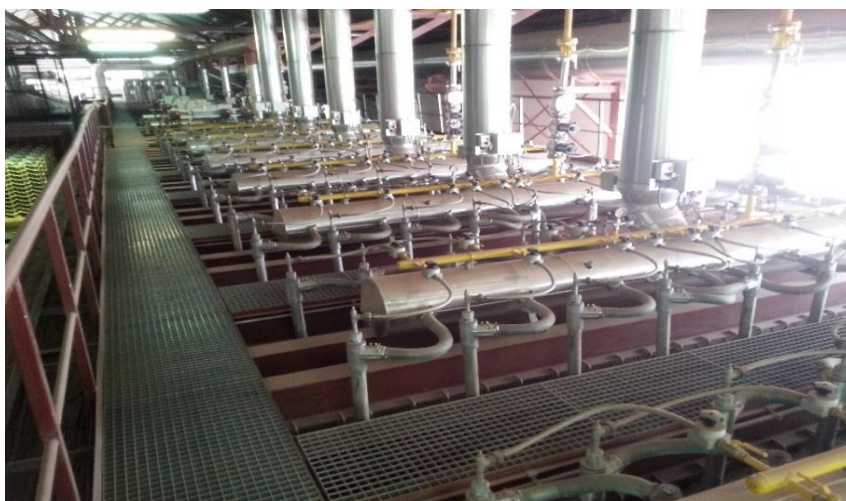
Slika 4.23. Ventili na peći koji doziraju plin
