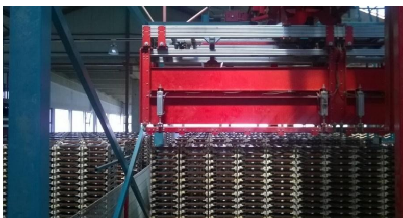
Slika 4.34. Skidanje crijepa s vagona
