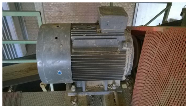
Slika 4.15. Asinkroni motor 2. valjka ispred prese
