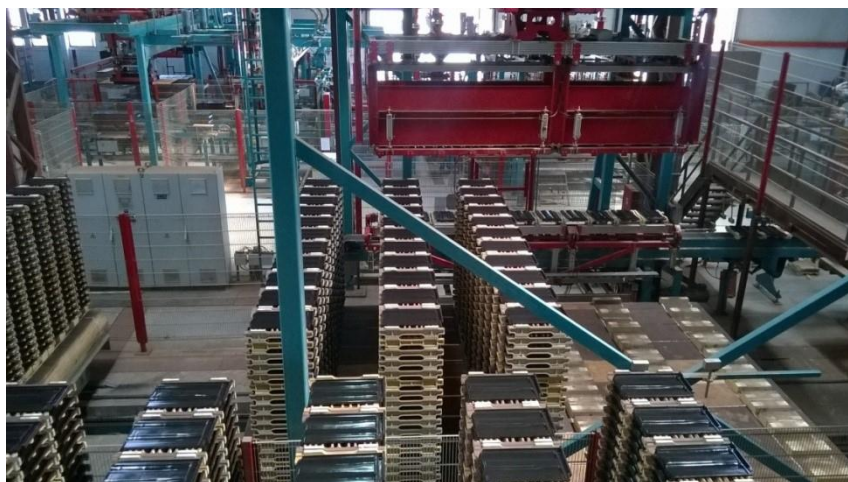
Slika 4.22. Crepovi se pripremaju za pečenje
