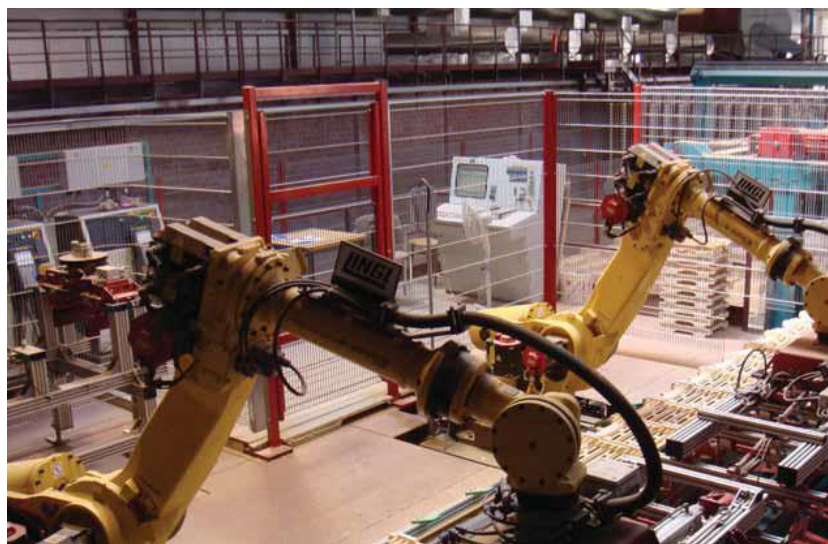
Slika 4.35. Slaganje crijepa na paletu
