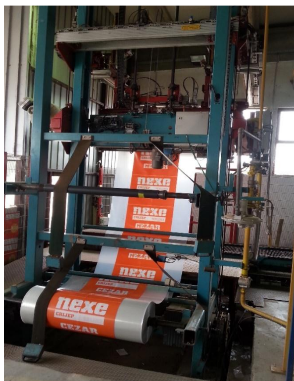
Slika 4.36. Stroj za omatanje palete najlonom
