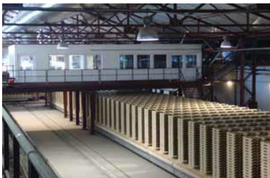
Slika 4.18. Glinene plastice prije ulaska u komoru za sušenje
