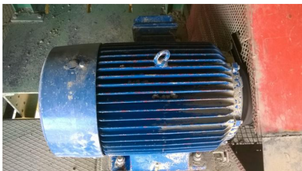
Slika 4.14. Asinkroni motor 1. valjka ispred prese
