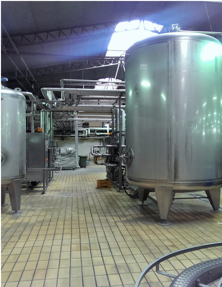
Slika 7.1. Tlačni tankovi u pogonu za pasterizaciju
