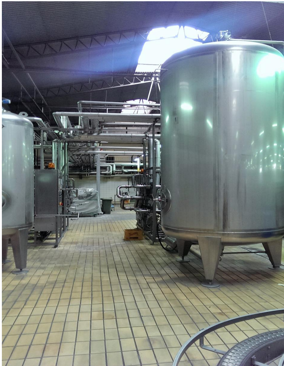
Slika 7.1. Tlačni tankovi u pogonu za pasterizaciju
