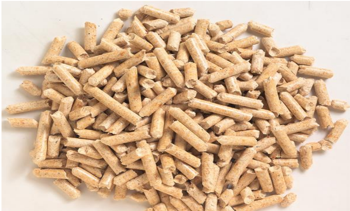
Slika 3.2. Peleti-najzastupljenija vrsta šumske biomase [4]
