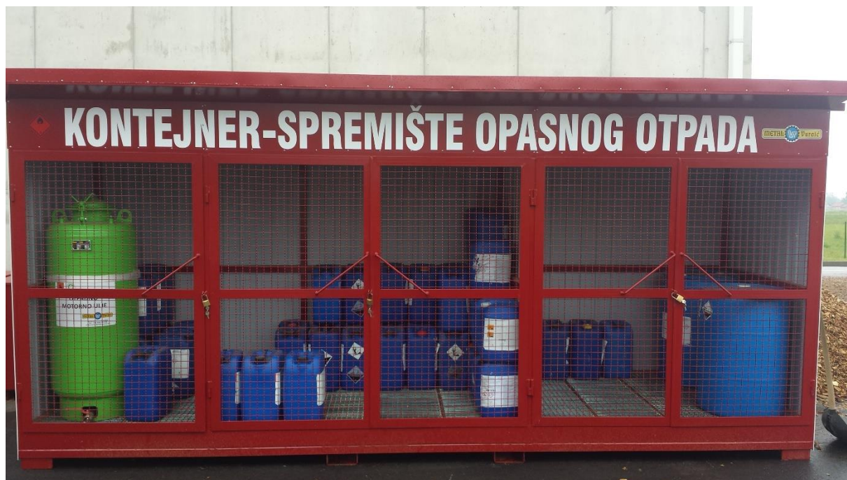
Slika 8.1. Kontejner za spremanje opasnog otpada [5]
