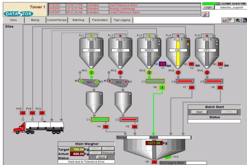
**Slika 3.20.** Prikaz SCADA sustava trinke Datastor [9]
