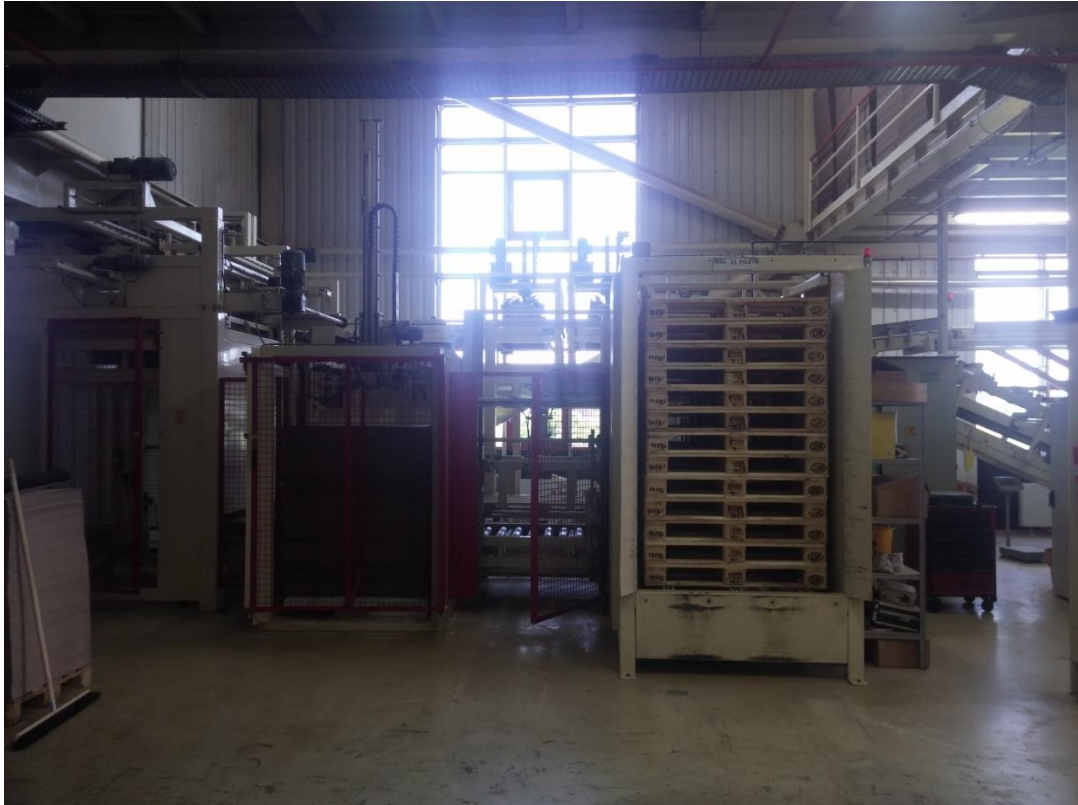
Slika 3.15. Prikaz stroja za slaganje vreća na palete
