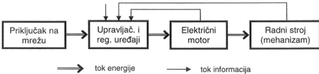
**Slika 2.4.** Shematski prikaz upravljanja elektromotornim pogonom [2]
