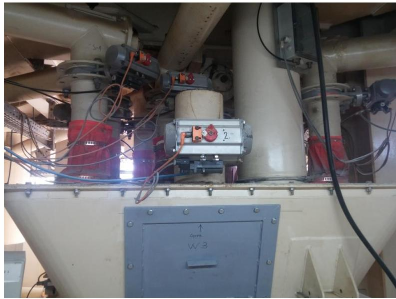
**Slika 3.9.** Prikaz vase 3 (manje točnosti), njenih motora i automatike
