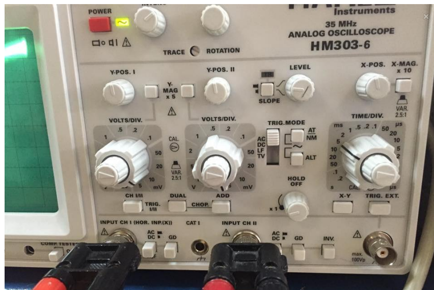
Sl. 4.3. Podešenja osciloskopa pri snimanju petlje histereze transformatora sa zračnim rasporom
