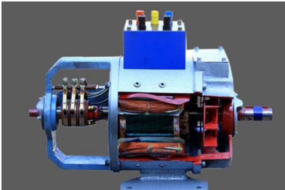
Slika 4.6. Presjek klizno kolutnog motora
