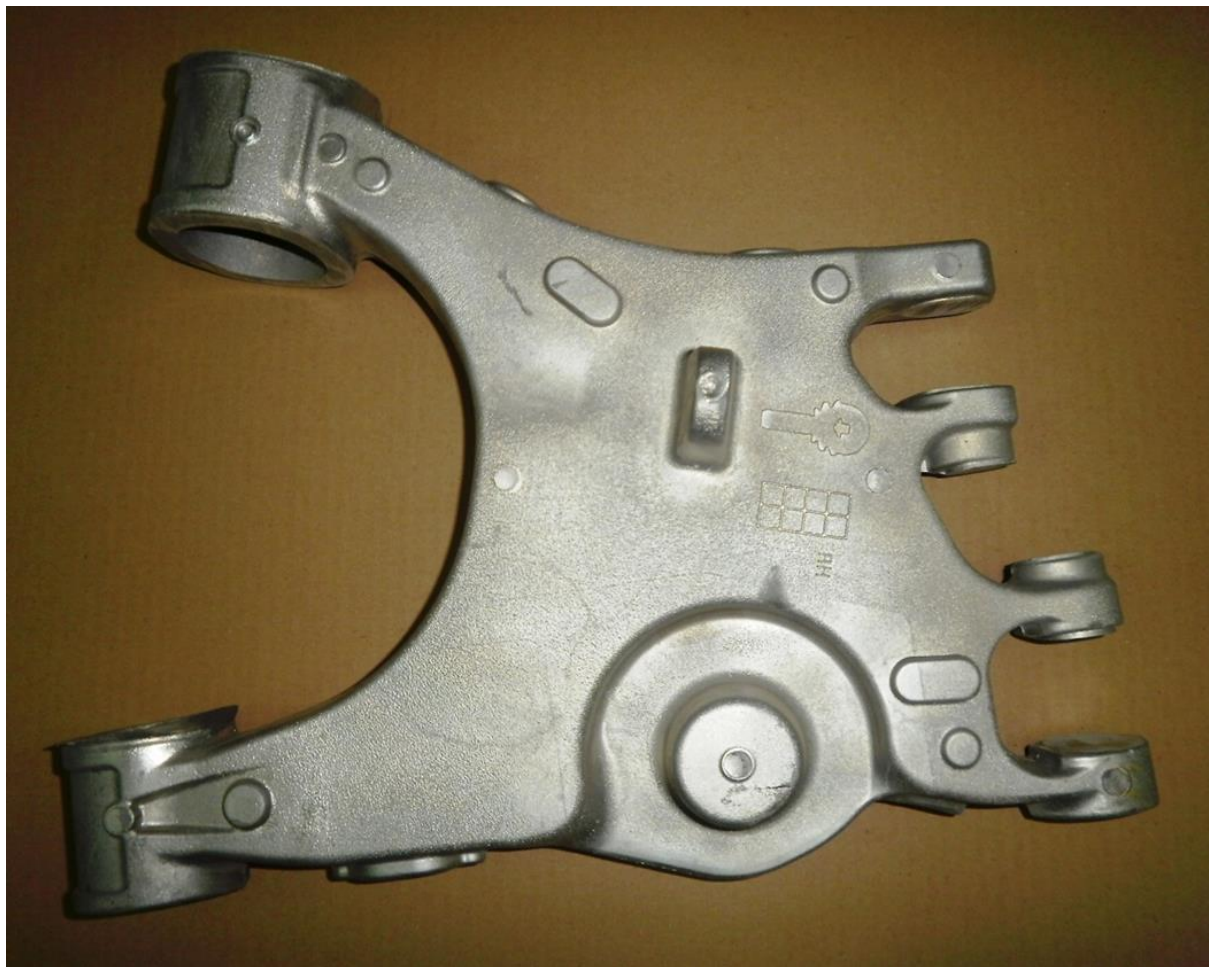
Slika 2.7. Izgled aluminijskog komada nakon uklanjanja pijeska
