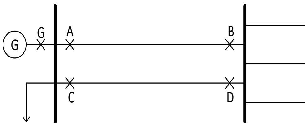
Slika 3.4. Prekidači duž dvostrukog voda koji se koriste kod prespajanja [10]
