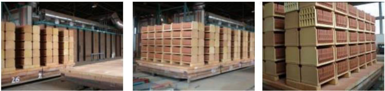
Slika 4.7. Izvoz crijepa iz peći [7, str. 21]
