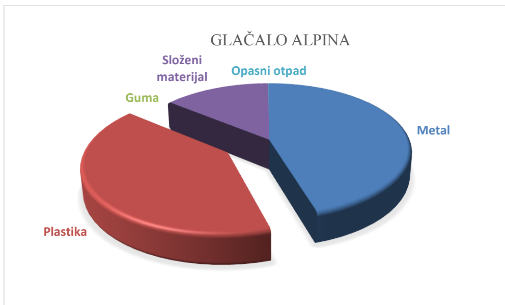
Slika 5.1: Grafikon zastupljenosti materijala u glačalu Alpina
