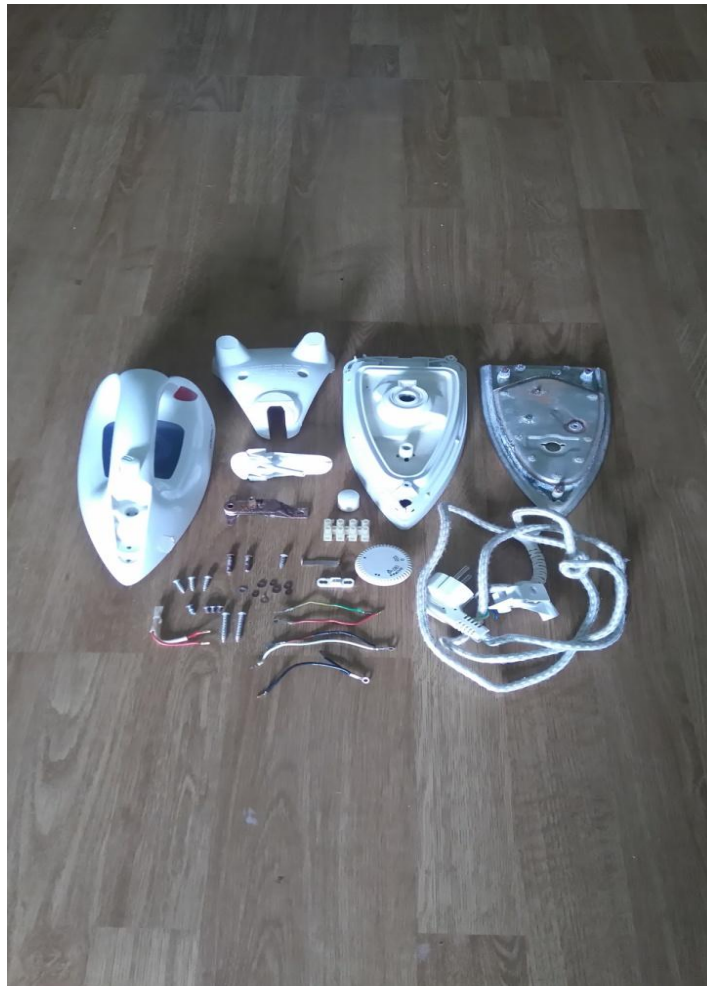
Slika 3.9: Prikaz rastavljenog glačala Eurotec
