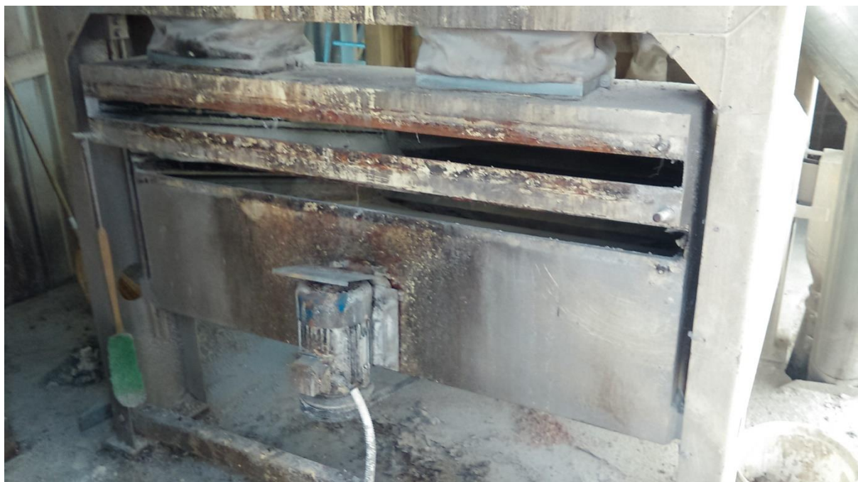
Slika 2.9. Sita u našem pogonu za sušenje žitarica
