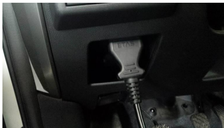
Slika 3.15. 16-pin DLC kabel za spajanje s osobnim automobilom
