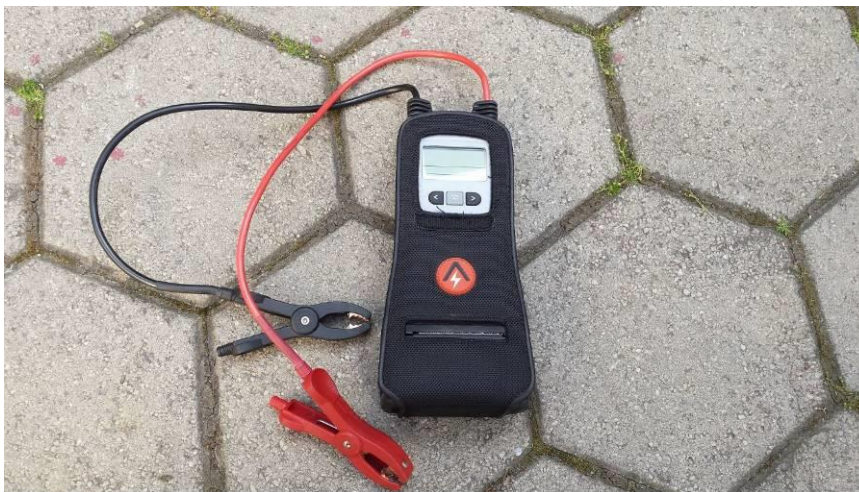
Slika 3.8. Uređaj za ispitivanje akumulatorske baterije ARGUS
