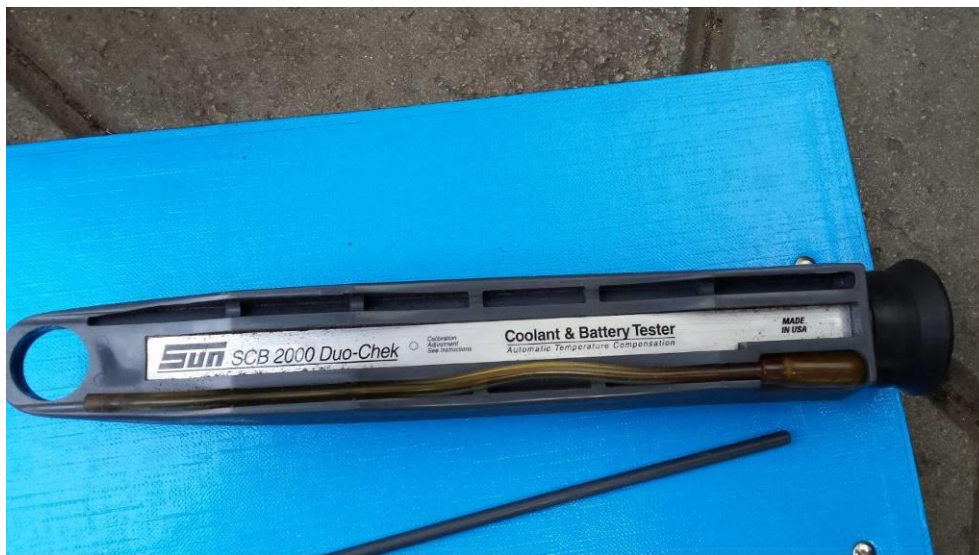
Slika 3.4. Optički uređaj za ispitivanje gustoće elektrolita
