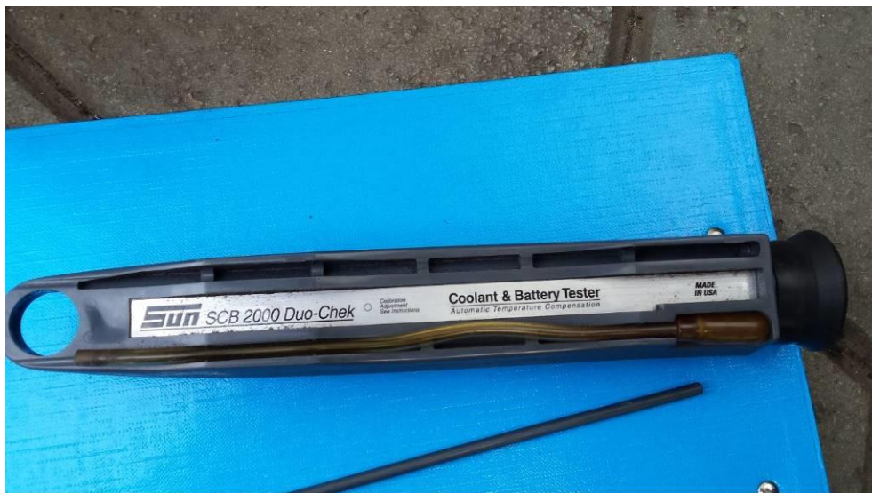
Slika 3.4. Optički uređaj za ispitivanje gustoće elektrolita
