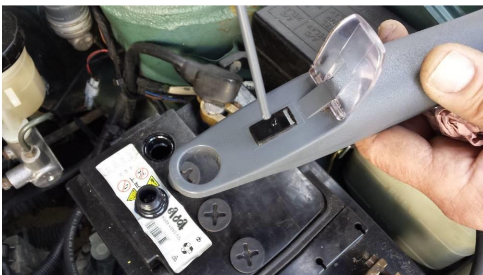
Slika 3.6. Nanošenje tekućine na podlogu za ispitivanje
