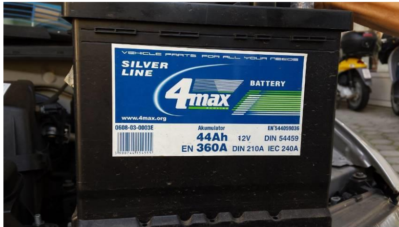
Slika 3.3. Slika ispitne akumulatorske baterije marke Silver line
