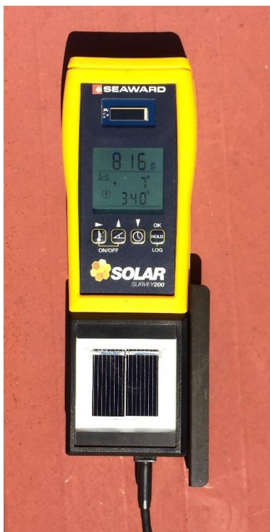
Slika 4.7. Mjerni instrument Seaward SOLAR Survey200 prilikom obavljanja mjerenja.
