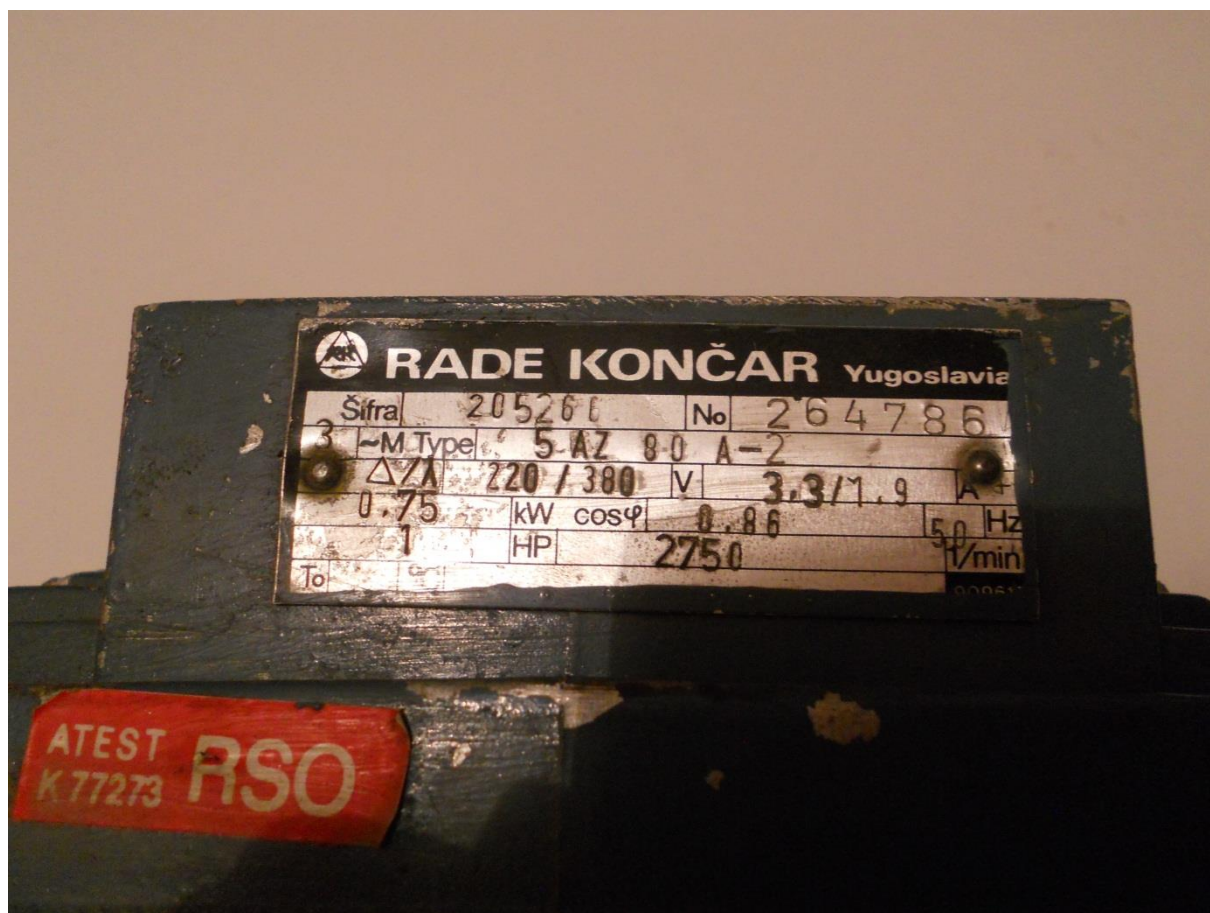
Slika 4.3. Natpisna pločica trofaznog asinkronog kaveznog elektromotora
