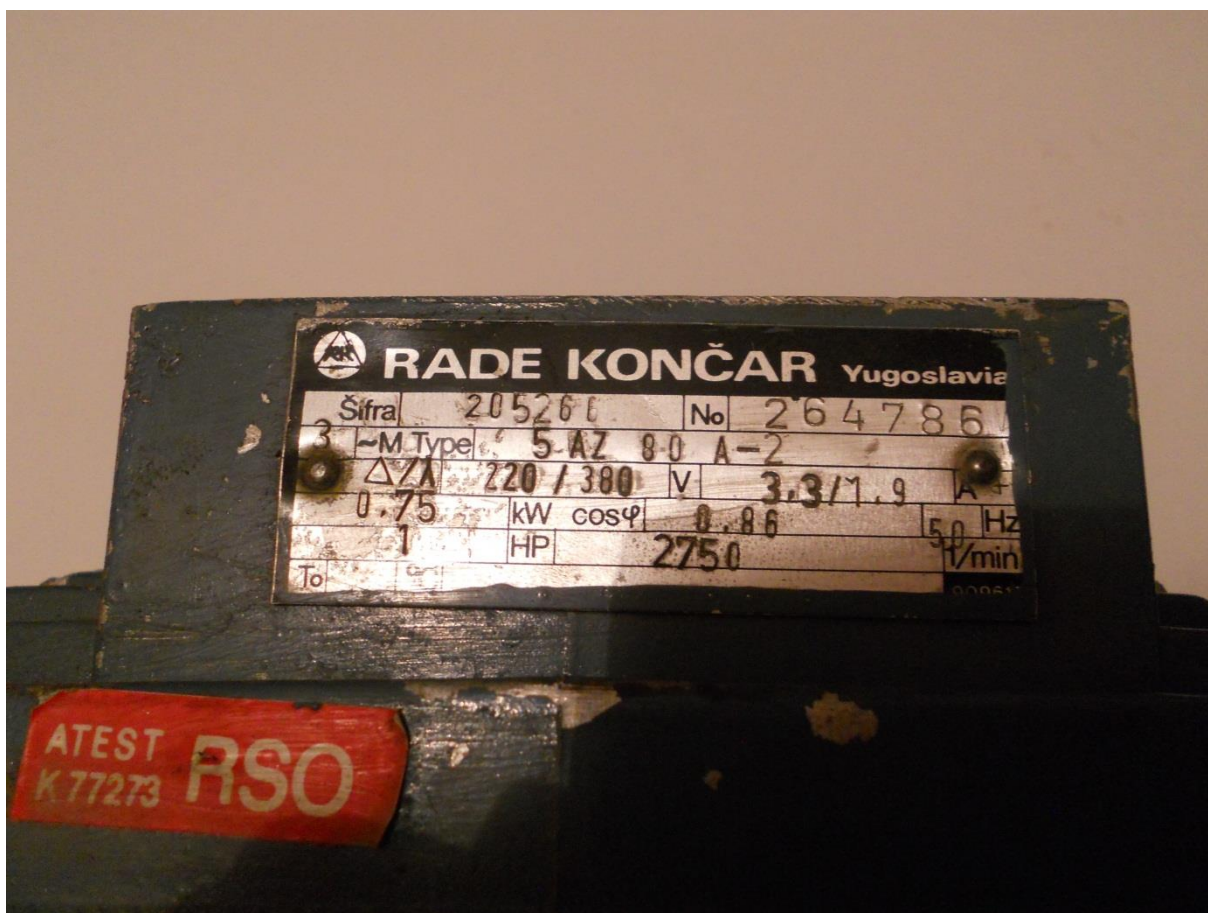
Slika 4.3. Natpisna pločica trofaznog asinkronog kaveznog elektromotora
