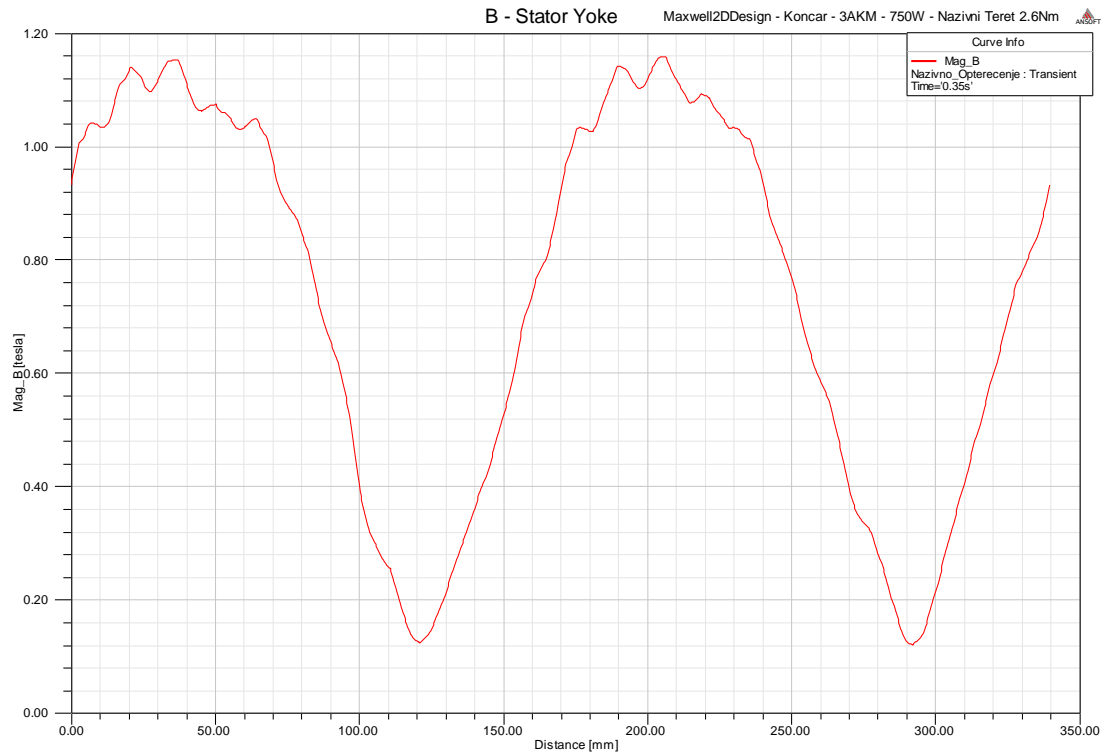
Slika 5.34. Magnetska indukcija B u statoru
