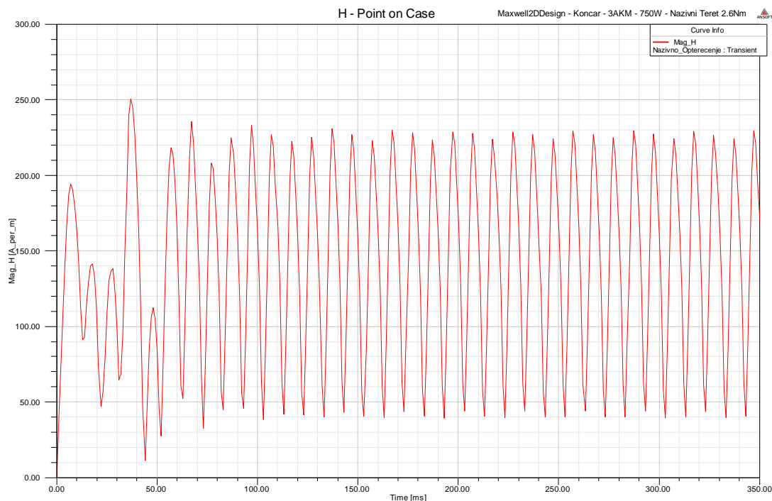
Slika 5.36. Jakost magnetskog polja H u točki na površini kućišta
