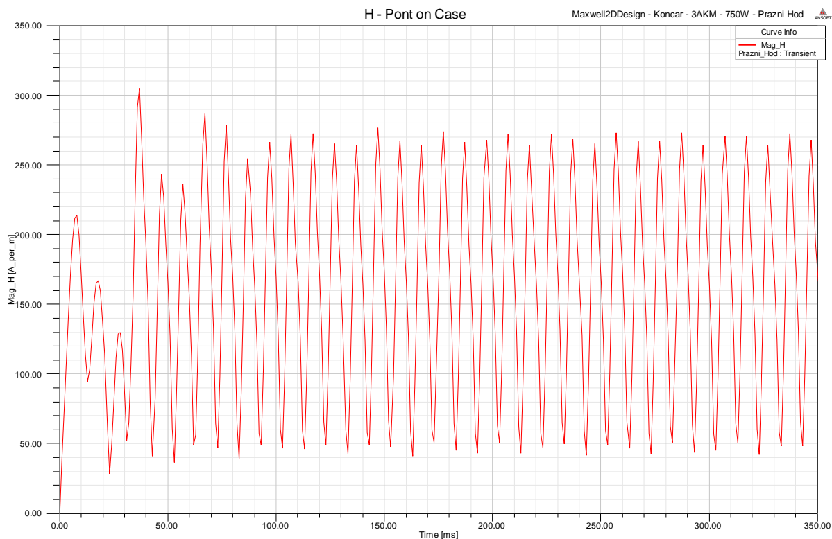
Slika 5.20. Promjena jakosti magnetskog polja H u točki na površini kućišta
