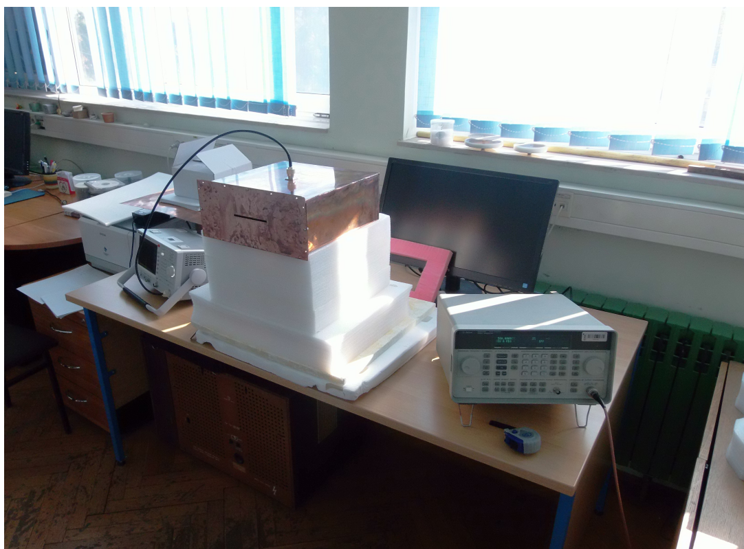
Sl. 4.7. Mjerenje djelotvornosti oklapanja za prvo kućište.
