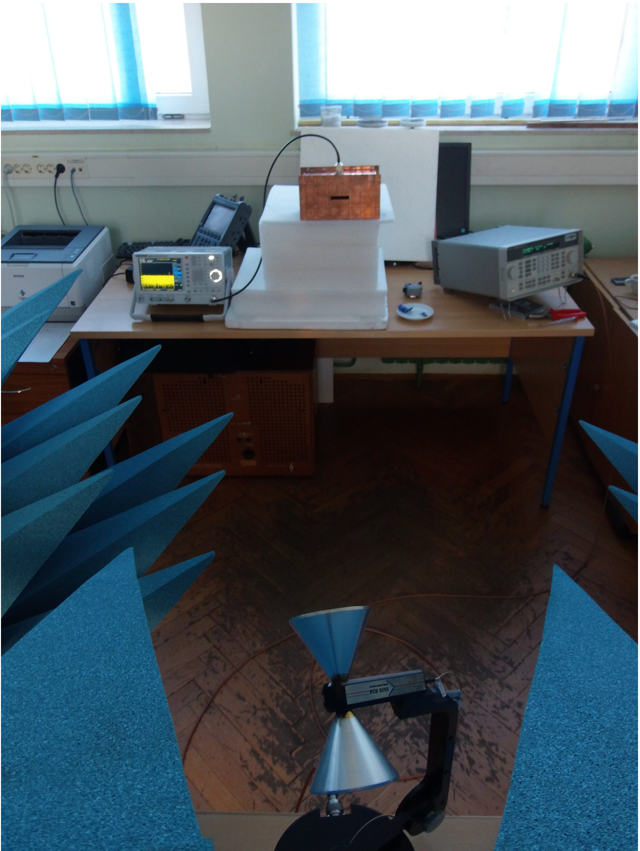
Sl. 4.13. Mjerenje djelotvornosti oklapanja drugog kućišta.
