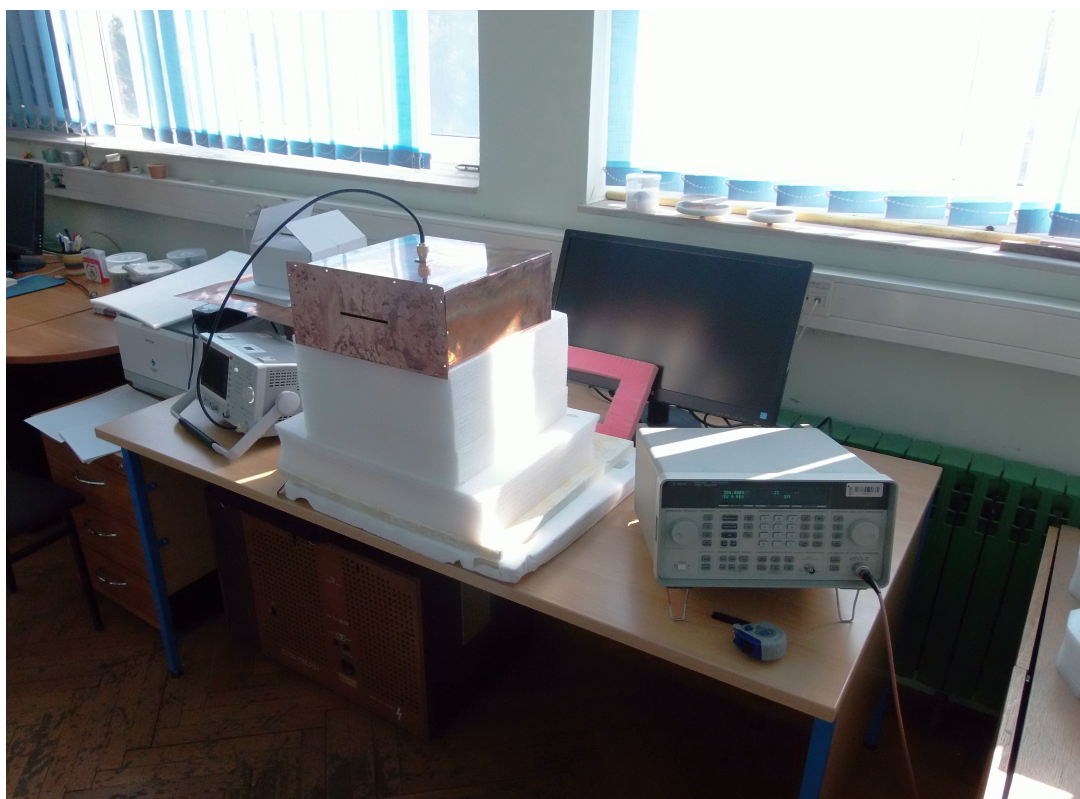
Sl. 4.7. Mjerenje djelotvornosti oklapanja za prvo kućište.
