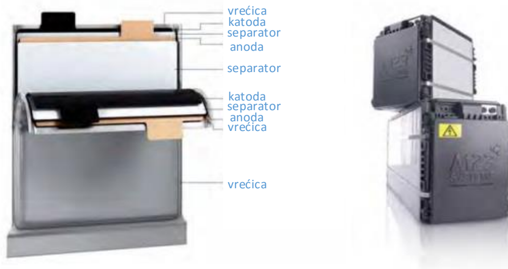
Slika 3.6 Tipični Li-ion dizajn u obliku prizme i baterijski moduli [3]
