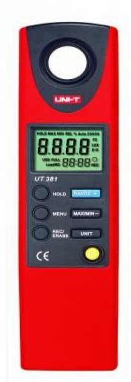
Slika 3.2.1. Digitalni luxmetar UNI-T UT 381 [21]
