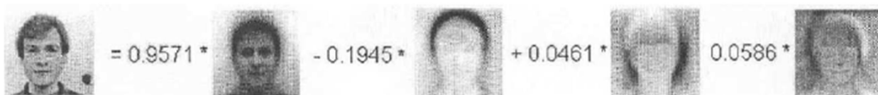
Sl. 7.2. Lice kao različita kombinacija eigenfaces (izvor: http://stephenpaulraj.com/face-detectionrecognition-eigenfaces )
