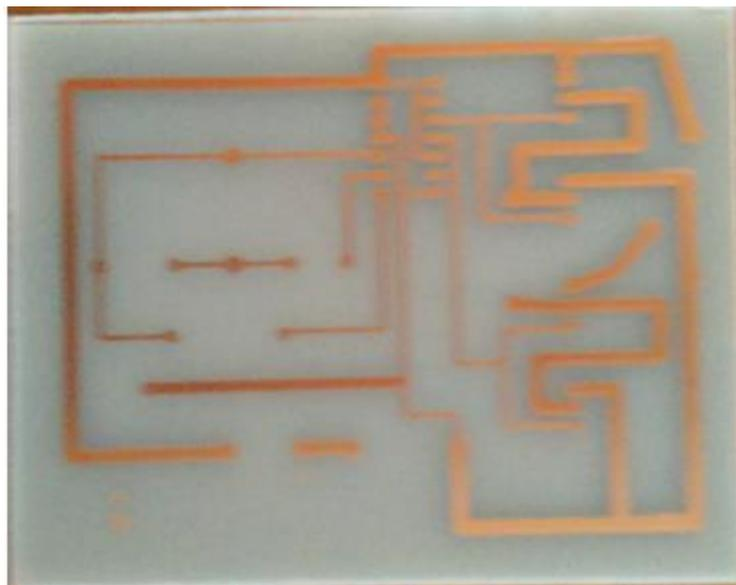
*Slika 2.5. Izgled tiskane pločice nakon skidanja bakra.*
