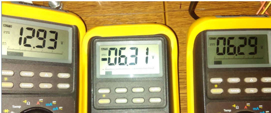
Slika 5.7. Srednje vrijednosti napona U_{GS} na P kanalnom MOSFET-u (negativno) i N kanalnom MOSFET-u (pozitivno) te ulazni napon.
