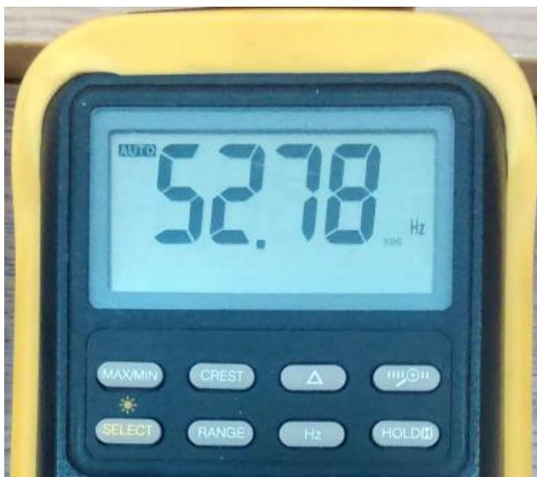
Slika 5.3. Izmjerena frekvencija na sekundarnim stezaljkama transformatora.
