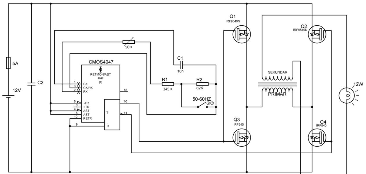
Slika 2.2. Promijenjena shema autonomnog naponskog neupravljivog izmjenjivača.
