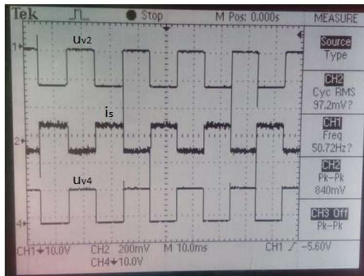
Slika 5.9. Valni oblici napona  $u_{v2}$ ,  $u_{v4}$  i struja trošila  $i_s$ .
