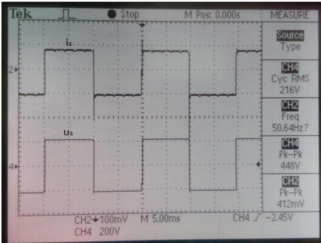
Slika 5.5. Valni oblici napona  $u_s$  i struje trošila  $i_s$ .
