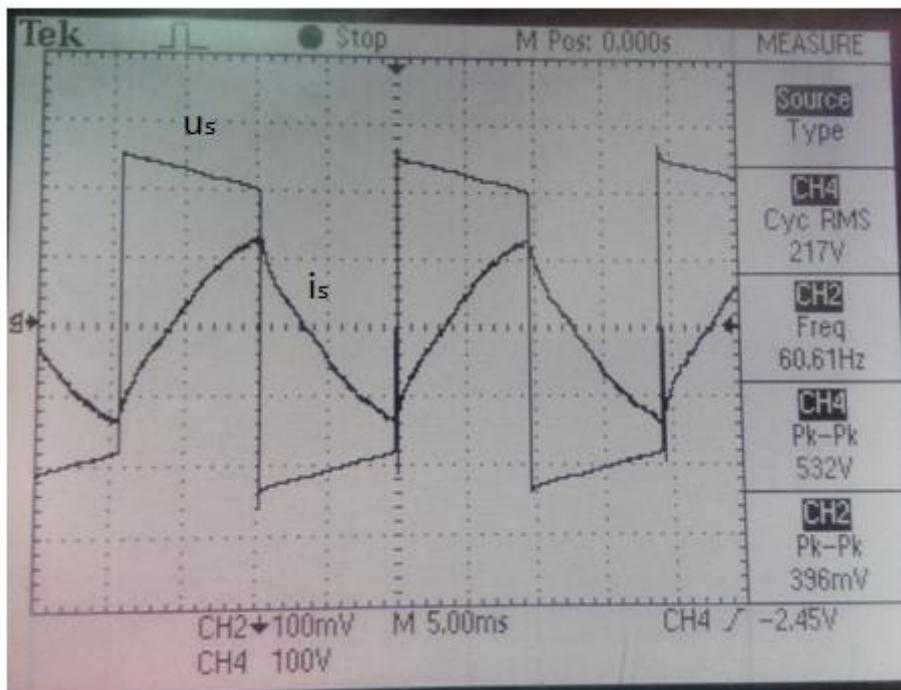
Slika 5.13. Valni oblik napona  $u_s$  i struje  $i_s$ .
