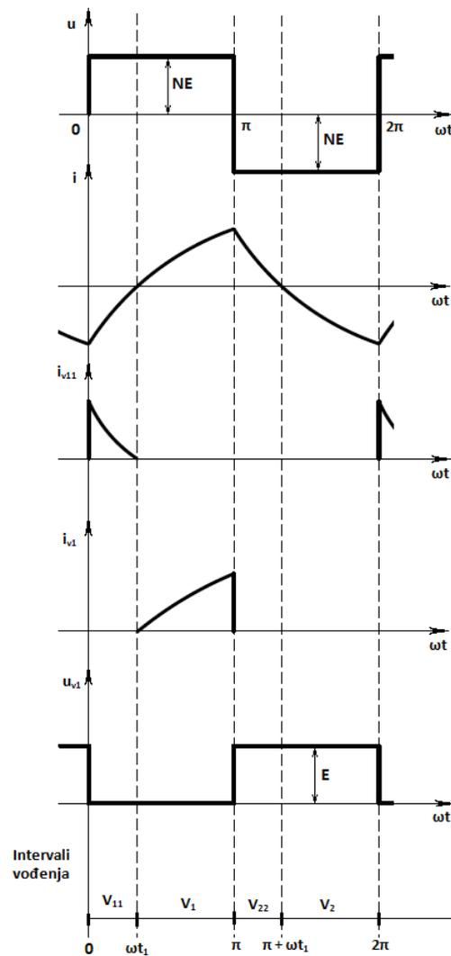
Slika 4.6. Karakteristični valni oblici napona i struja izmjenjivača.
