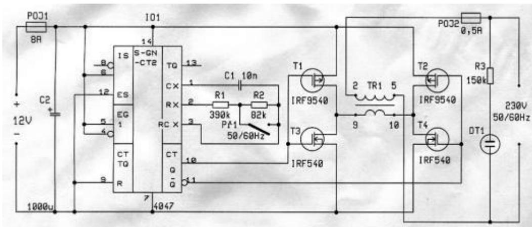
Slika 2.1. Shema autonomnog naponskog neupravljivog izmjenjivača preuzeta iz [1].
