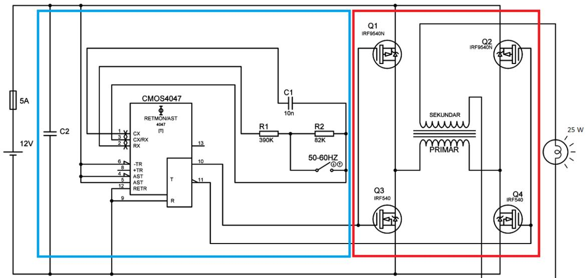
Slika 2.1. Shema izmjenjivača na kojem se vrši rekonstrukcija.
