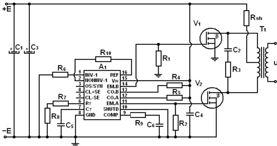
Slika 5.7. Shema spoja autonomnog nereguliranog naponskog izmjenjivača.
