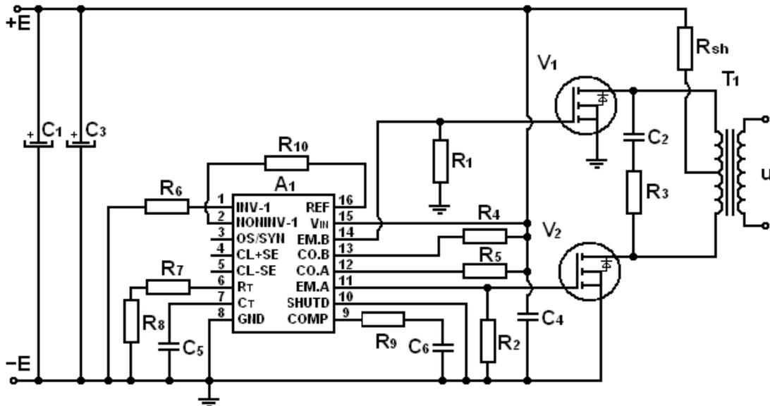
Slika 5.6 Shema spoja autonomnog nereguliranog naponskog izmjenjivača.
