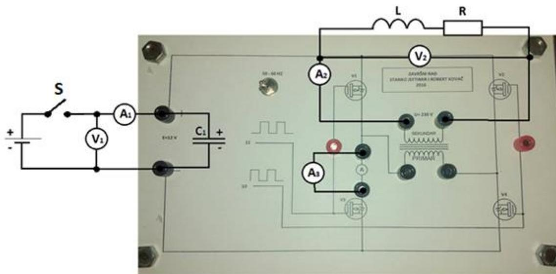
Slika 5.11. Shema spajanja makete izmjenjivača s ostalom opremom.
