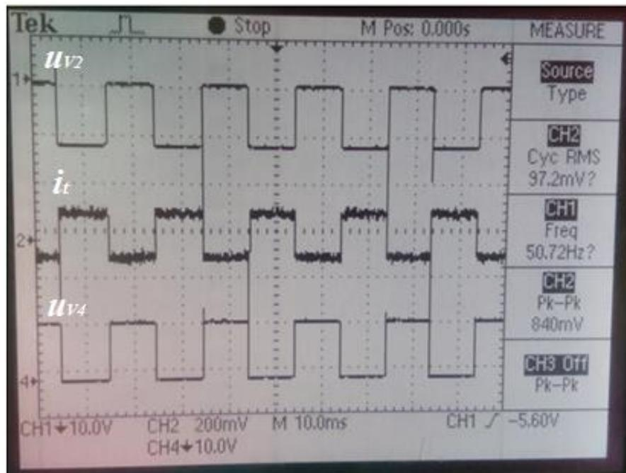
Slika 4.9. Napon na ventilima V2;  $u_{v2}$  i V4;  $u_{v4}$ , te struja trošila;  $i_t$ .
