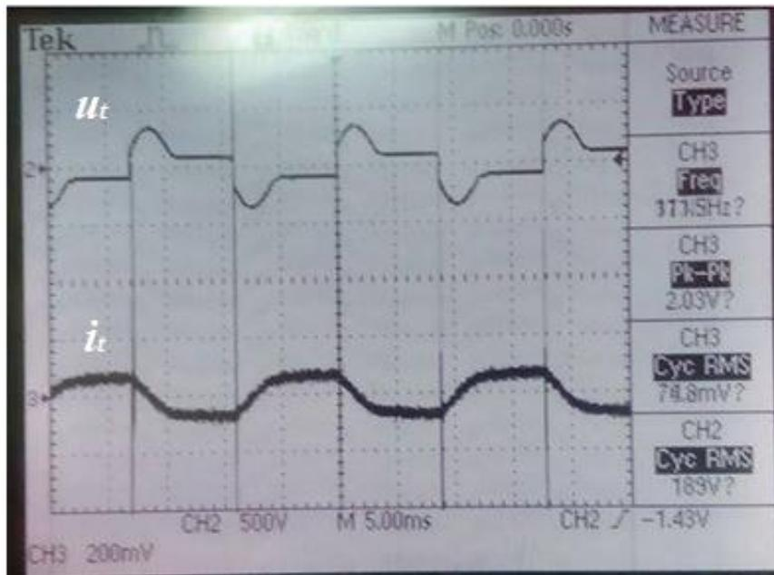
Slika 4.14. Napon;  $u_t$  i struja;  $i_t$  trošila bez dodatnog kondenzatora na izlazu iz izvora napajanja.
