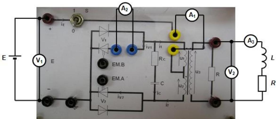
Slika. 5.9. Shema spajanja makete izmjenjivača s ostalom opremom.
