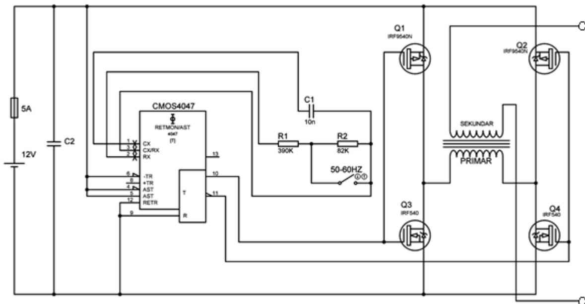
Slika 5.8. Fizički model pretvarača u mosnom spoju.
