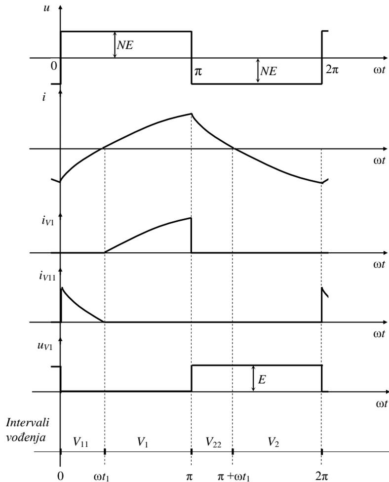
Slika. 5.5. Karakteristični valni oblici napona i struja izmjenjivača.
