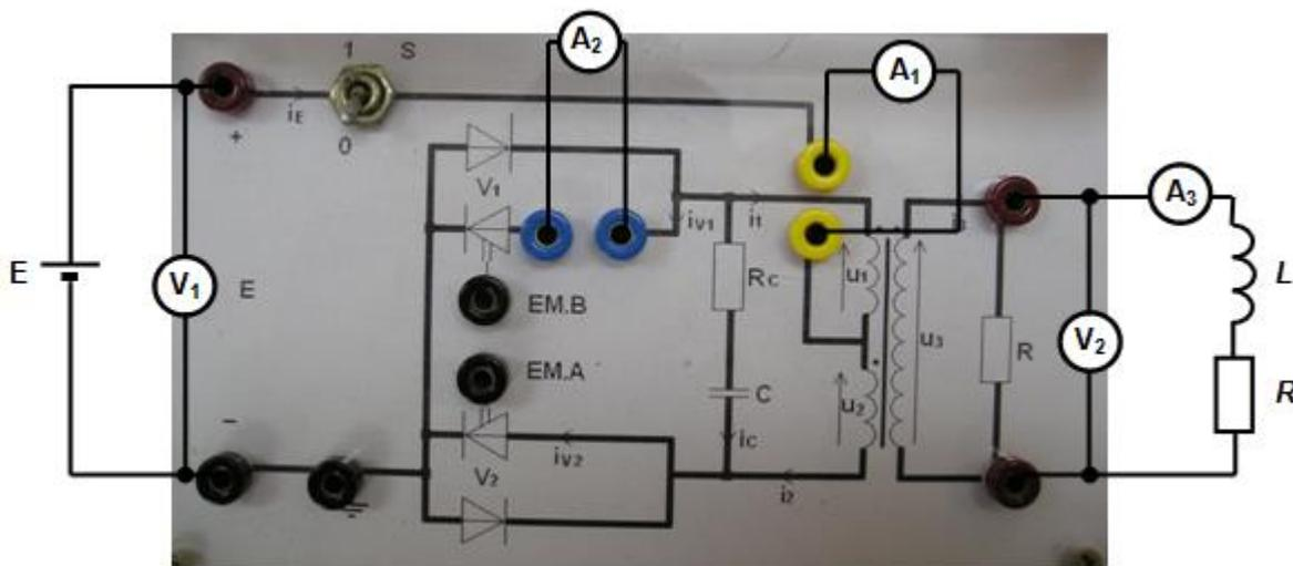
Sl. 5.7. Shema spajanja makete izmjenjivača s ostalom opremom.
