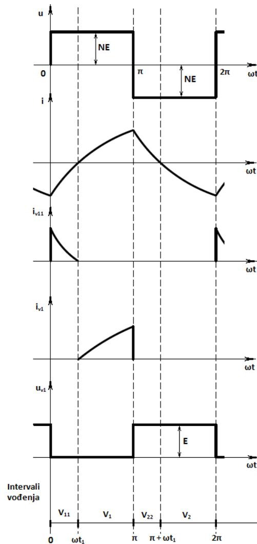
Slika 3.6. Karakteristični valni oblici napona i struja izmjenjivača.
