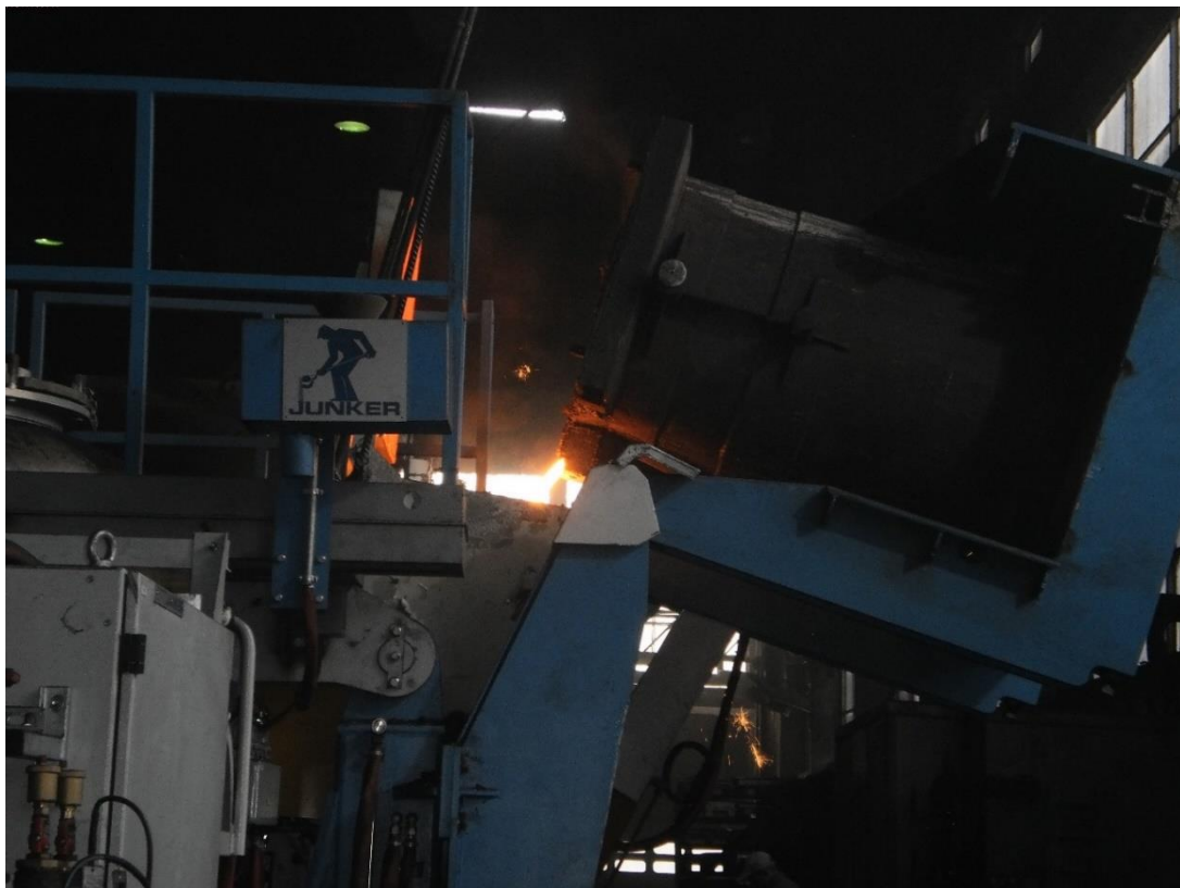
Slika 4.3. Lijevanje taline iz lijevačkog lonca u agregat za lijevanje (fotografirano 5.2.2016)
