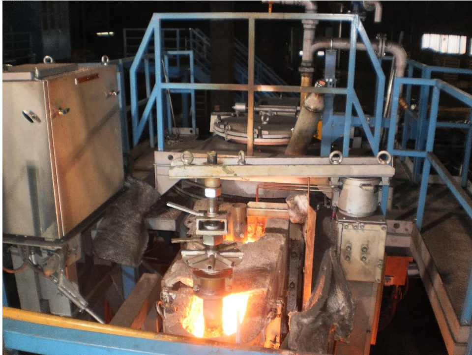
Slika 6.3. Grafitna štanga-proces lijevanja u tijeku ( fotografirano 5.2.2016 )
