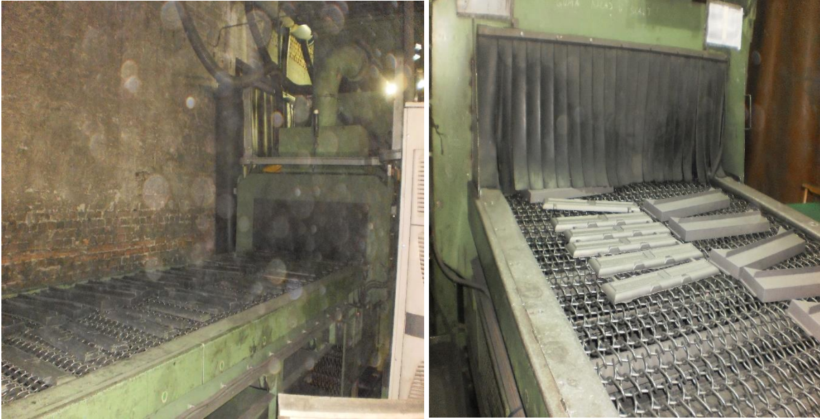
Slika 6.5. Ulaz i izlaz čistilice odlijevaka (fotografirano 5.2.2016)
