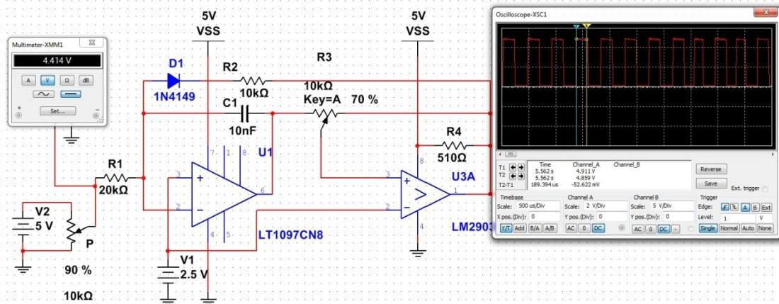
Slika 24 Simulacijski model PF modulatora i mjerjenje trajanja visoke razine signala za  $V_{in}=4,414\text{V}$
