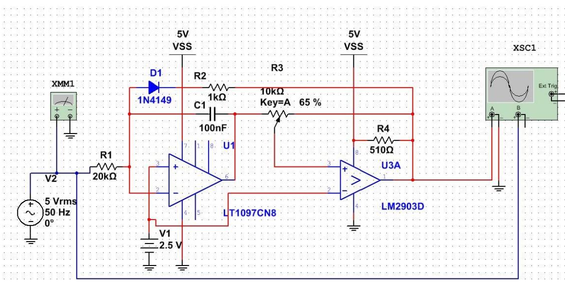
Slika 31 Električna shema PF modulatora primjenjena u simulaciji
