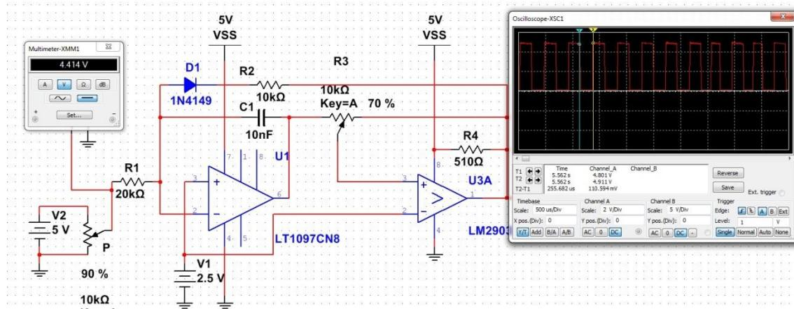
Slika 25 Simulacijski model PF modulatora i mjerjenje trajanja niske razine signala za  $V_{in}=4,414\text{V}$
