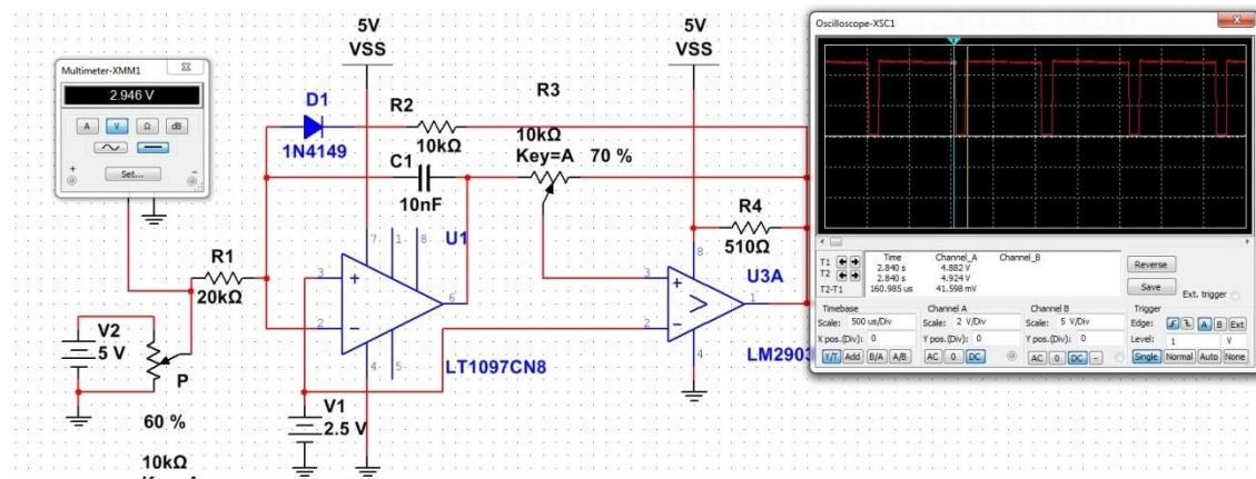
Slika 23 Simulacijski model PF modulatora i mjerjenje trajanja niske razine signala za  $V_{in}=2,946V$
