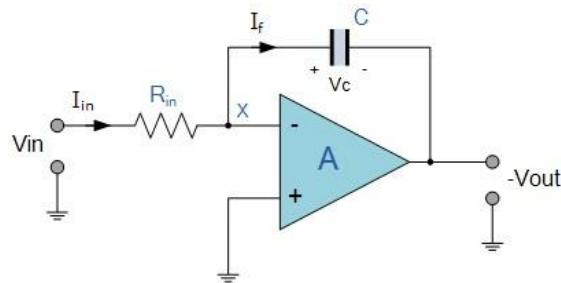
Slika 18 Sklop integrator izведен operacijskim pojačalom
