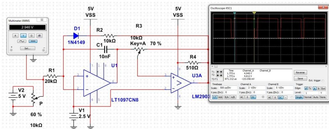
Slika 22 Simulacijski model PF modulatora i mjerjenje trajanja visoke razine signala za  $V_{in}=2,946V$
