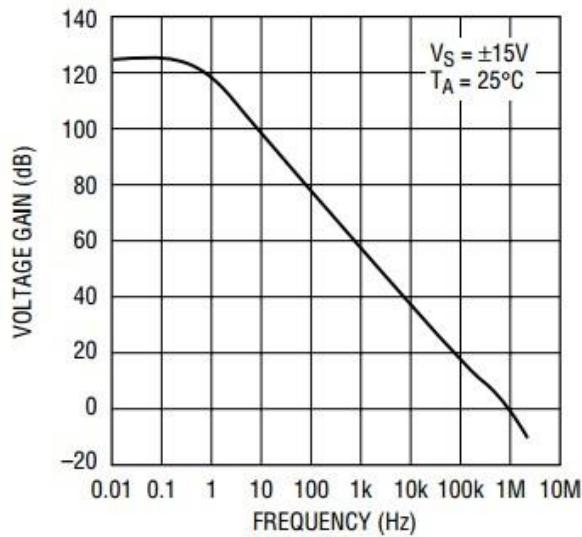
Slika 13 Karakteristika pojačanja u ovisnosti o frekvenciji
