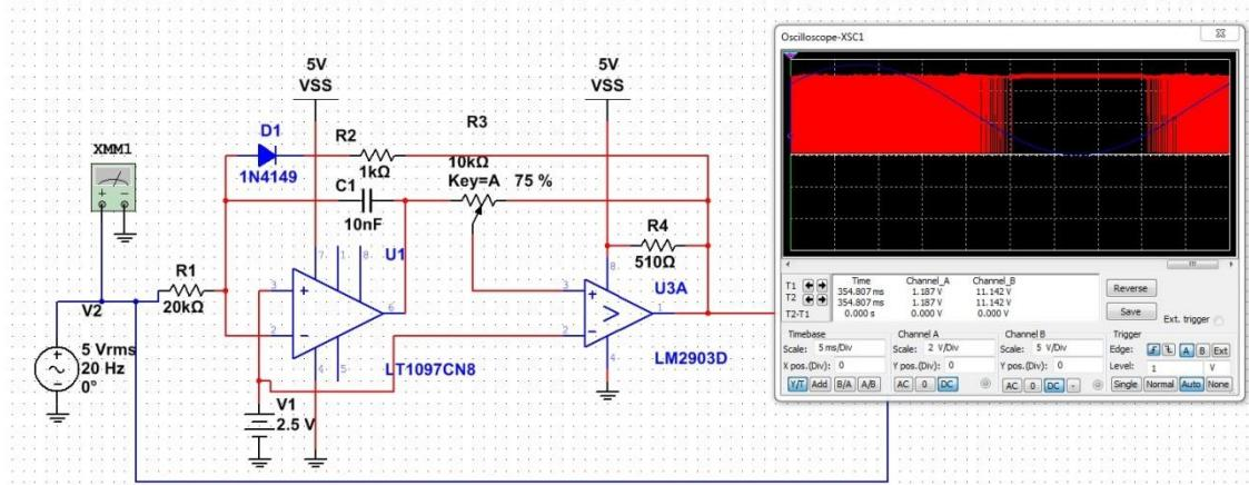
Slika 28 Odziv sklopa uz ulaznu sinusoidu frekvencije 20Hz
