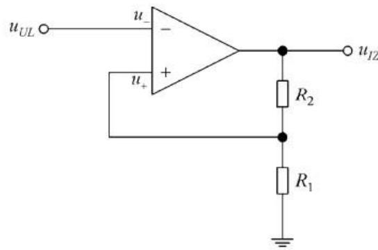
Slika 19 Sklop komparatora
