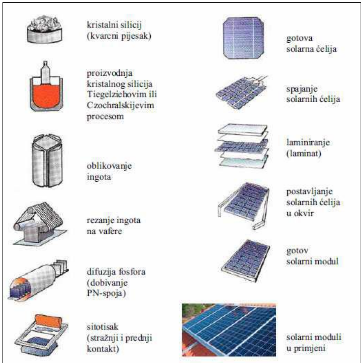
Slika 3.7. Postupak proizvodnje ćelija i solarnih panela [1]
