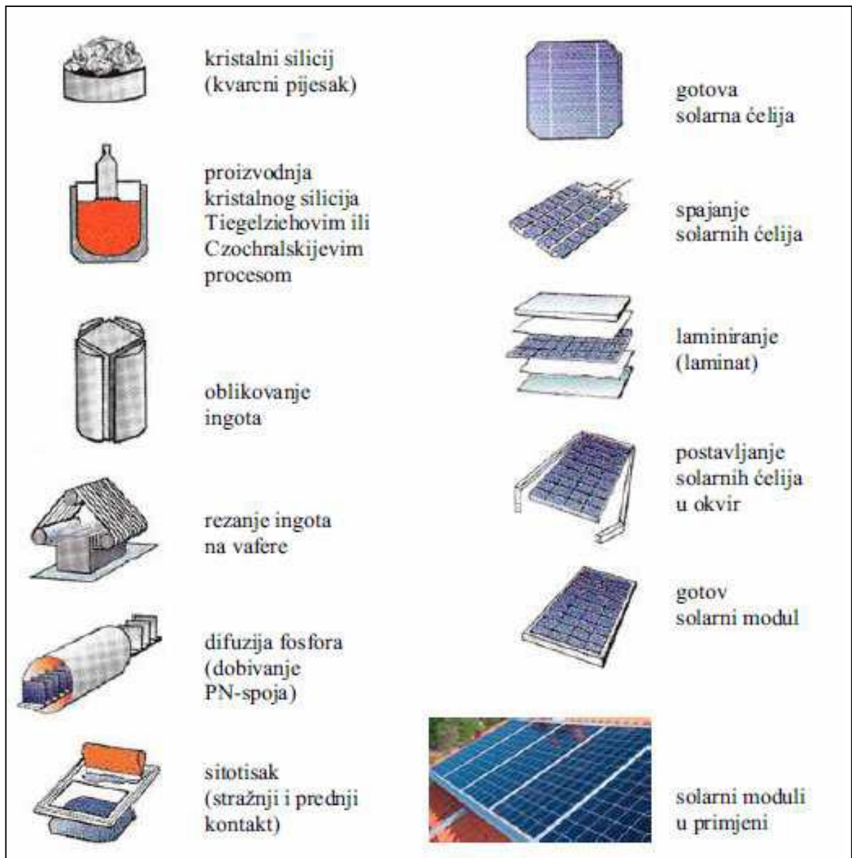
Slika 3.7. Postupak proizvodnje ćelija i solarnih panela [1]
