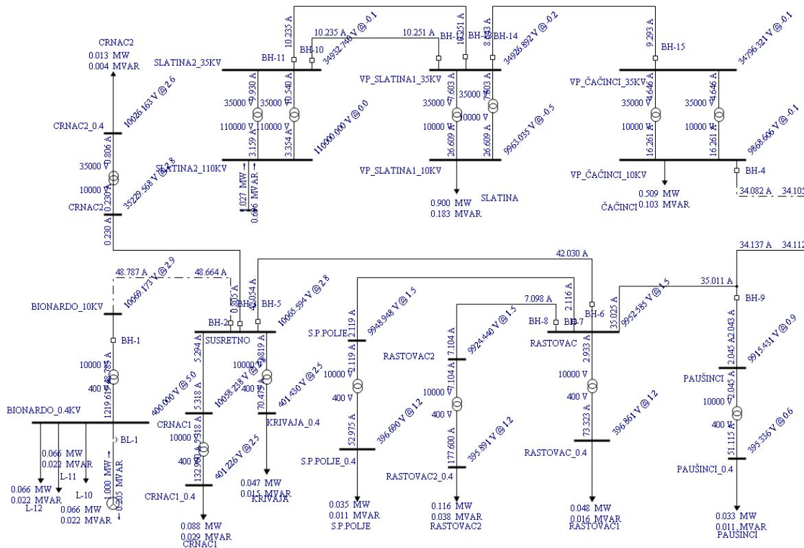
Generator BP postrojenja je priključen na sabirnicu BIONARDO\_0.4KV preko niskonapaonskog prekidača. Sam generator je definiran kao PV čvor snage 1 MW i napona 1 p.u. i za navedene postavke u mrežu daje 1 MW radne snage dok iz mreže uzima 235 kVAR. Pravidna snaga troplnog kratkog spoja mreže iznosi 1582 MVA, podatak dobiven iz prijenosne mreže Slavonije za područje Slatina proračunom snage troplnog kratkog spoja u programskom paketu Dig SILENT.
