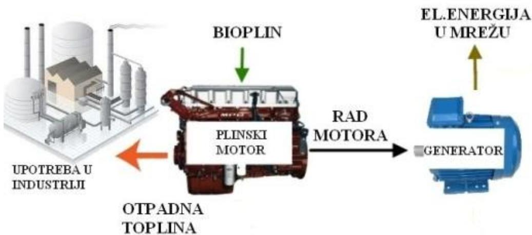
*Slika 18. Princip rada bioplinskog postrojenja [19]*
