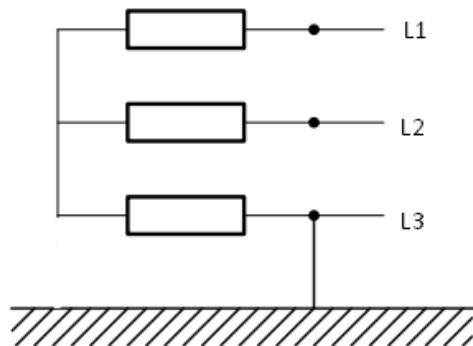
Slika 17. Jednopolni kratki spoj sa izoliranim zvjezdishtem transformatora
