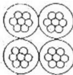
*Slika 8. Poprečni presjek samonosivog kabelskog snopa[8]*
