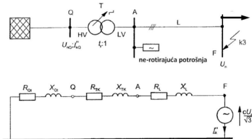
*Slika 10. Sheme elektroenergetskog sustava i nadomjesni elementi sheme[17]*
