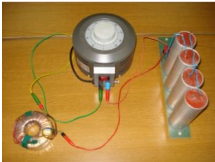
Slika 3.11. Laboratorijski ferorezonantni krug
