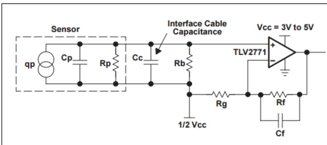
Slika 2.6. Napon pojačanja kruga Senzor model, slika preuzeta iz [9]
