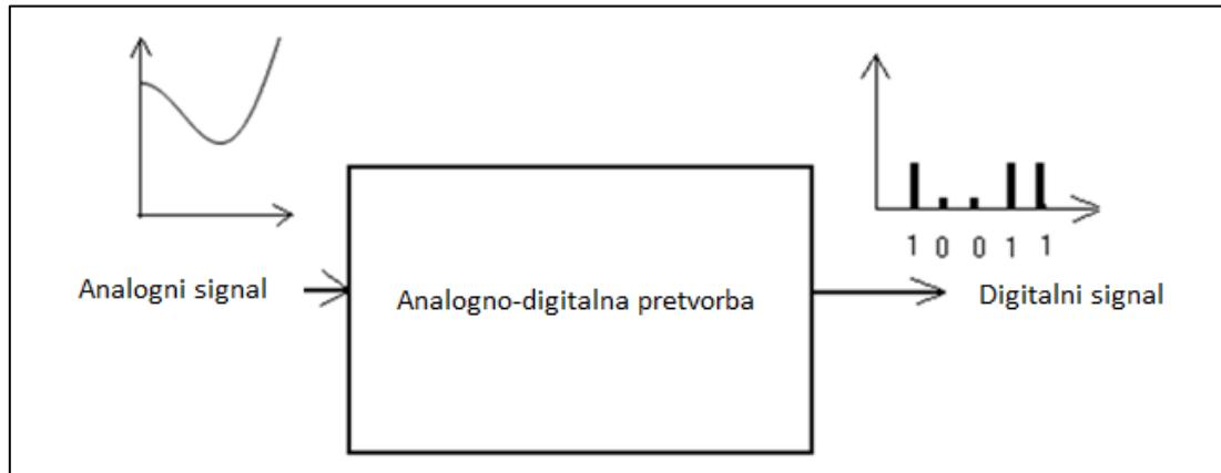
Slika 3.1. Analogno-digitalna pretvorba, slika preuzeta iz [18]
