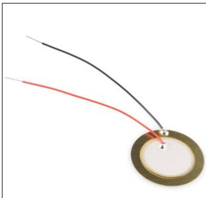
Slika 2.4. Piezo senzor, slika preuzeta iz [16]
