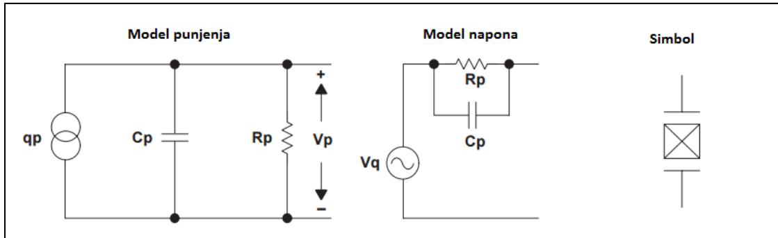
Slika 2.5. Senzor model, slika preuzeta iz [9]
