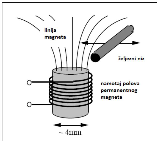
**Slika 2.9.** Shematski dijagram jednostavnog pickup-a, slika preuzeta iz [18]
