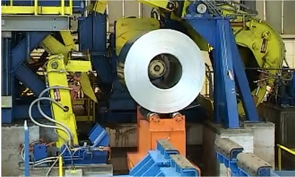
Slika 3.1. Sustav za transport namotaja
