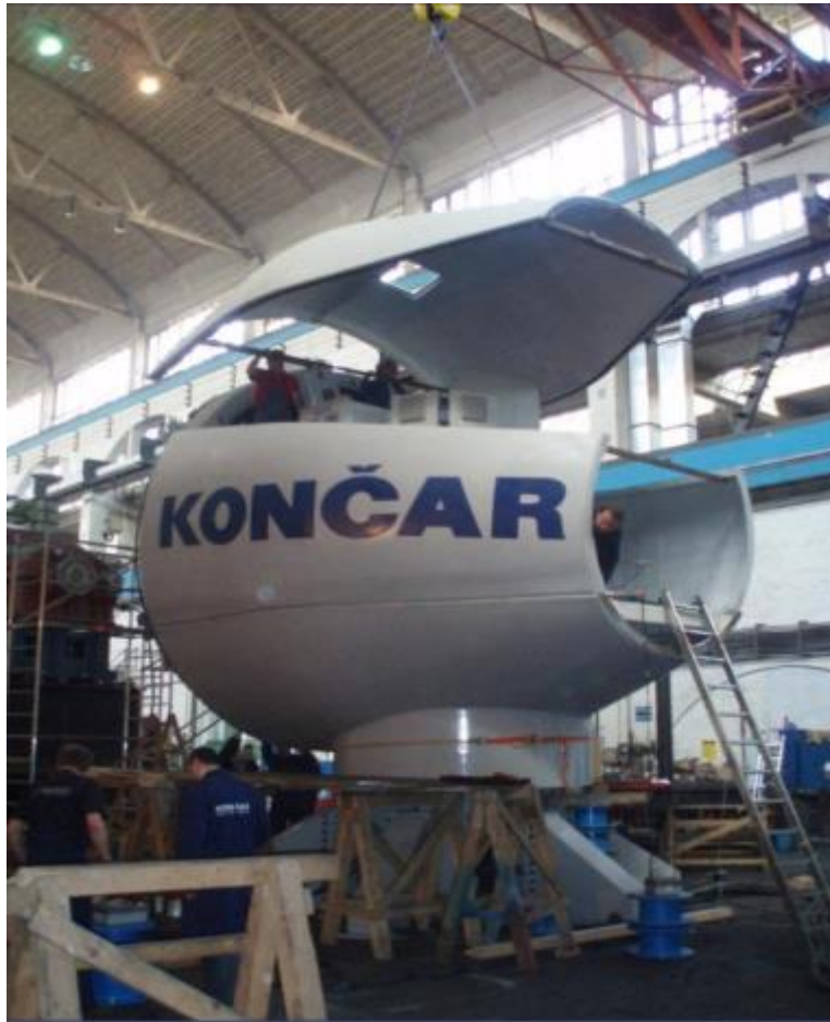
Slika 4.9: Kućište u proizvodnji
