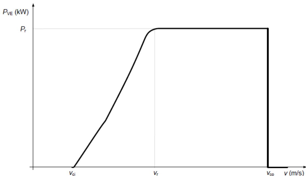
Slika 2.11: Krivulja snage vjetroelektrane
