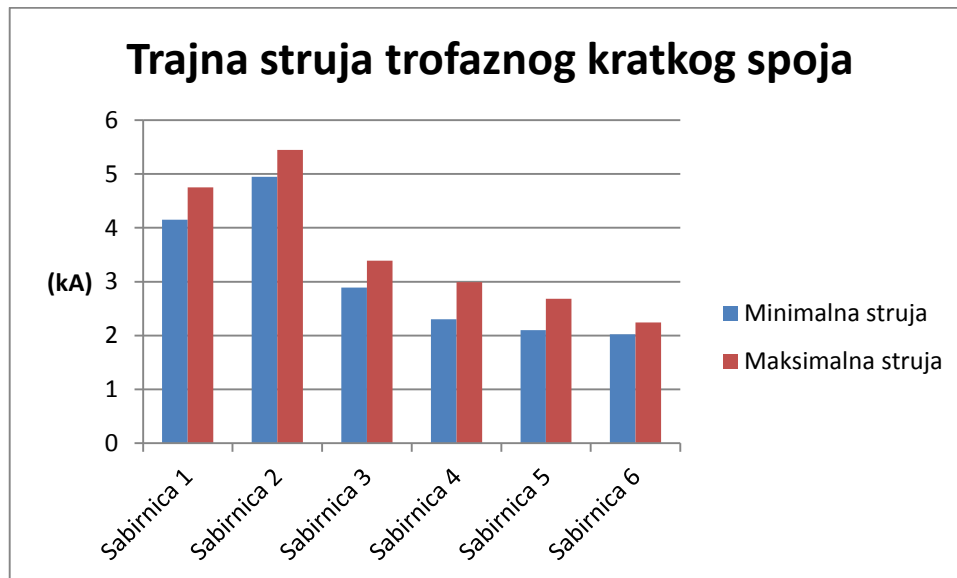
Slika 4.14: Vrijednost maksimalne i minimalne trajne struje trofaznog kratkog spoja I_k
