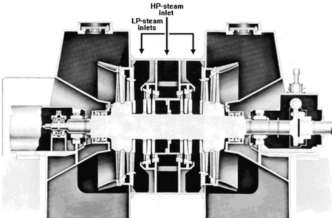
Sl. 5.7 Poprečni presjek parne turbine [2]
