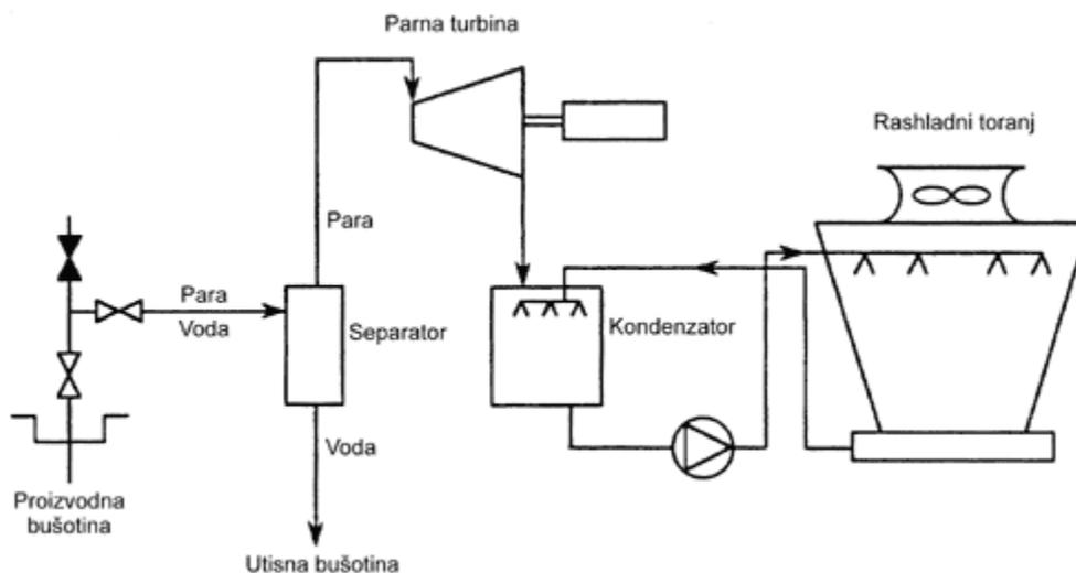
Sl. 5.1 Shema geotermalne elektrane sa separiranjem pare [7]
