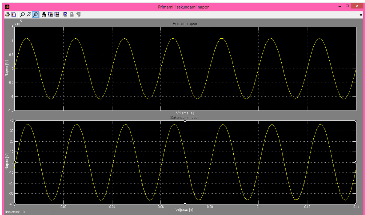
Slika 4.3. Primarni i sekundarni napon za RL trošilo
