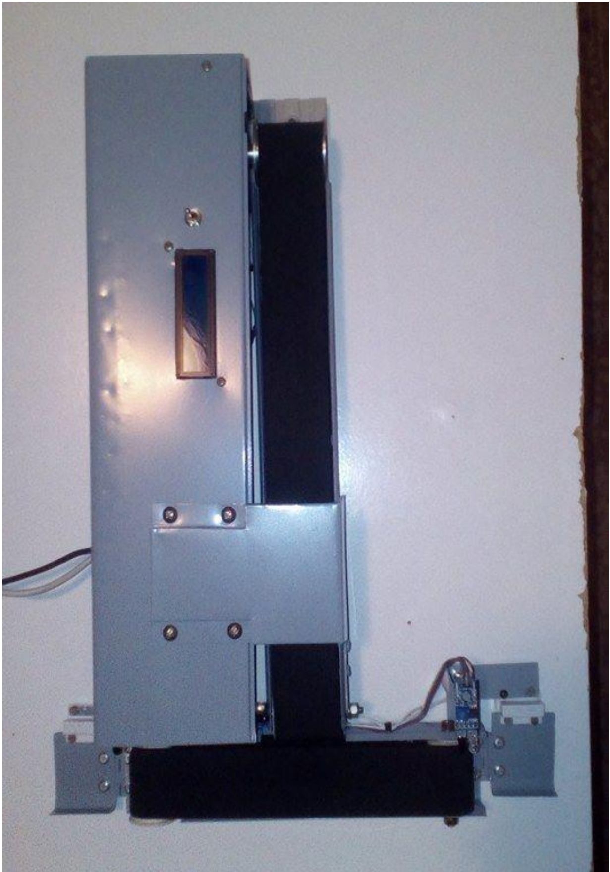
Sl. 3.5. Maketa sustava za sortiranje proizvoda prema boji.
