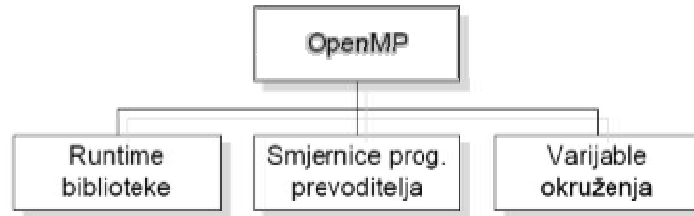
Sl. 2.3. Komponente OpenMP standarda, iz [7].
