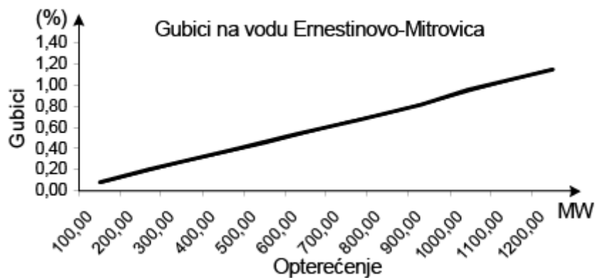
Slika 4.3. Dijagram ovisnosti relativnih djelatnih gubitaka o opterećenju[10].
