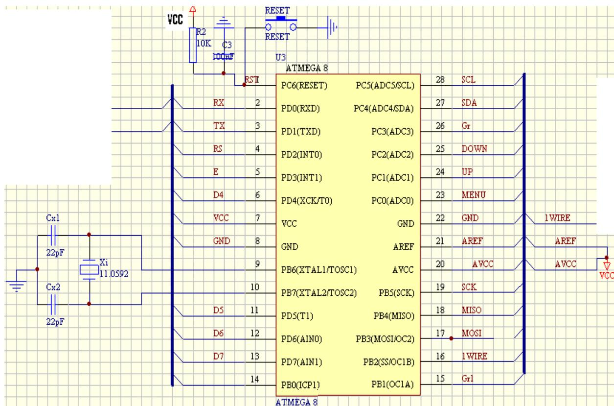
Slika 3.8: Električna shema cjelokupnog upravljačkog dijela sklopa
