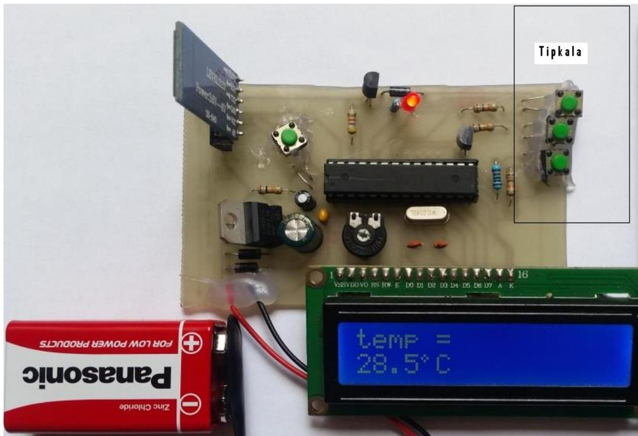
Slika 2.3: Sklop s označenim mjestom tipkala *Menu*, *Up* i *Down*
