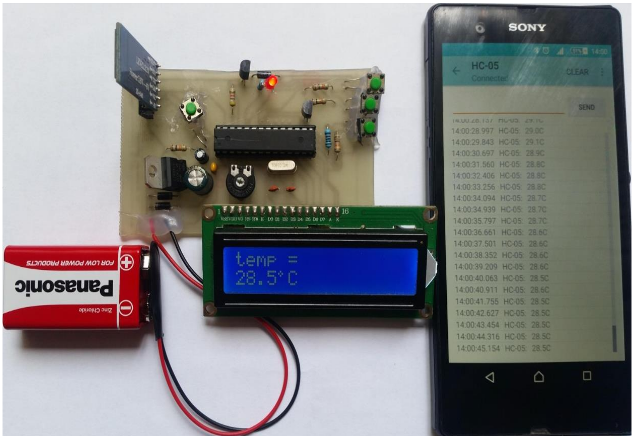
Slika 2.2: Prikaz funkcionalnosti sklopa i pametnog telefona
