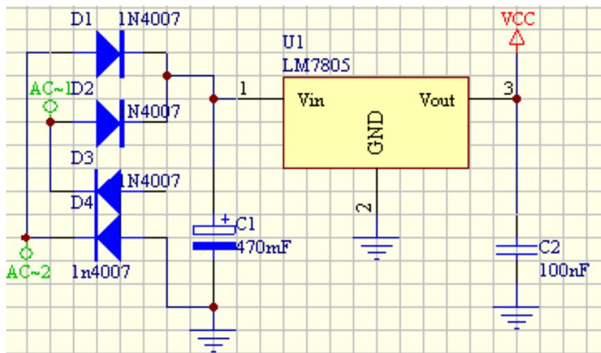
Slika 3.1: Električna shema napajanja
