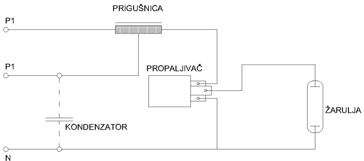
**Slika 2.11.** Shema spajanja visokotlačne natrijeve i metalhalogene žarulje i njihove predspojne naprave
