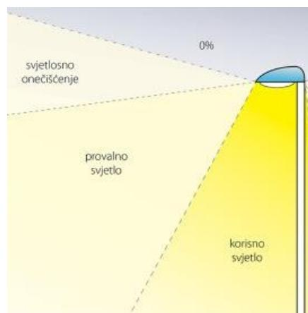
**Slika 3.4.** Svjetlosno onečišćenje kod svjetiljke zaobljene optike
