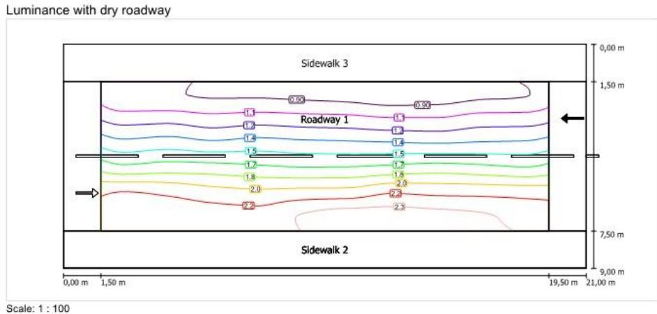
**Slika 5.19.** Prikaz sjajnosti cijele površine kolnika obasjanog LED izvorom u Dialux-u
