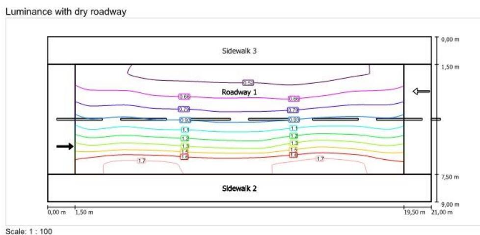
**Slika 5.17.** Prikaz sjajnosti cijele površine kolnika rasvjetljenog živinim izvorom svjetlosti u Dialux-u
