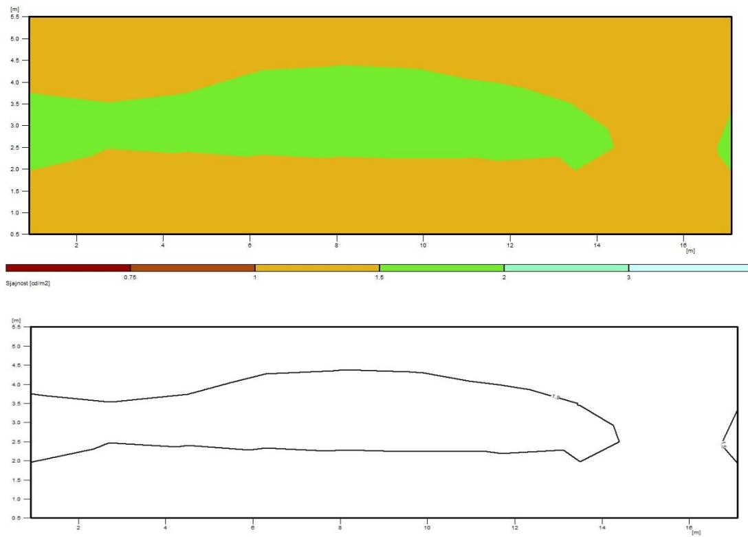
**Slika 5.7.** Prikaz sjajnosti kolnika za visokotlačni natrij u pojedinim točkama, te pomoći izolinija i pseudo boja
