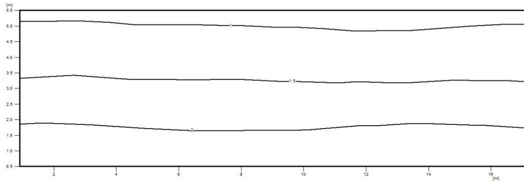
**Slika 5.8.** Prikaz sjajnosti kolnika za LED u pojedinim točkama, te pomoću izolinija i pseudo boja
