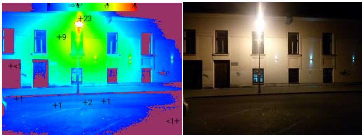
Slika 5.20. Prikaz sjajnosti kolnika u različitim točkama pomoću Photolux-a
