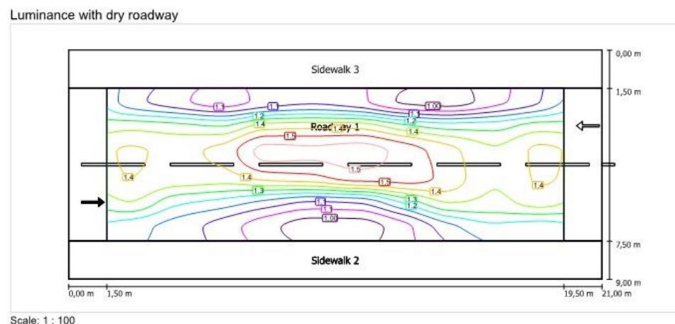
**Slika 5.18.** Prikaz sjajnosti cijele površine kolnika obasjanog visokotlačnim natrijem u Dialux-u
