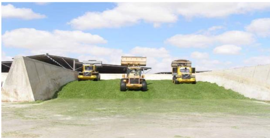
Slika 2.8. Bunker silosi za skladištenje [4]
