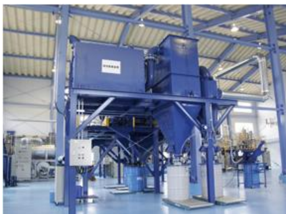
Slika 4.8. Jedinica postrojenja za sakupljanje fosfornog praha sa živom
