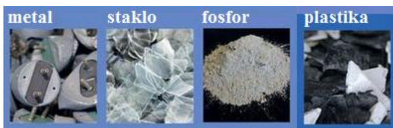
Slika 4.12. Dobiveni resursi potpunim recikliranjem rasvjetnih tijela [24]
