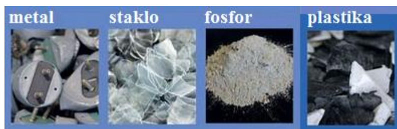
Slika 4.12. Dobiveni resursi potpunim recikliranjem rasvjetnih tijela [24]
