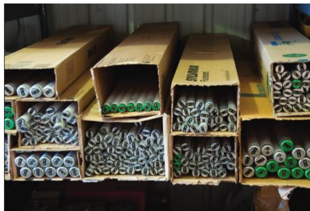
Slika 4.2. Preporučljivo odlaganje istrošenih rasvjetnih tijela (fluo cijevi)
