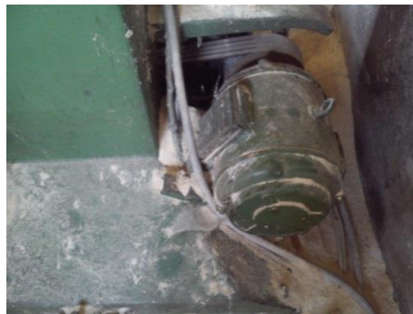
Slika 5.5. Elektromotor koji pogoni pilu stroja
