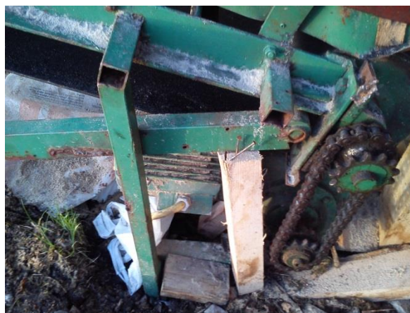
Slika 6.2. Mehanizam pokretne trake
