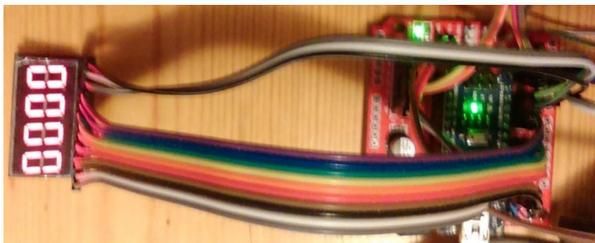
Slika 4.7. Spoj sedam segmentnog pokazivača i Arduina
