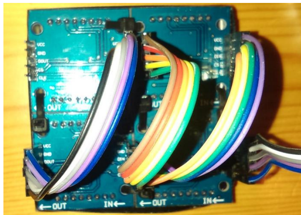
Slika 4.9. Međusobno povezivanje više modula
