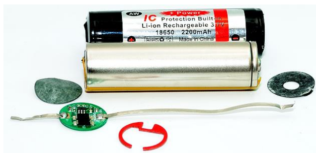
Sl. 3.25. prikaz konstrukcije 18650 baterije. [Izvor: http://www.lygte-info.dk/info/battery%20protection%20UK.html ]
