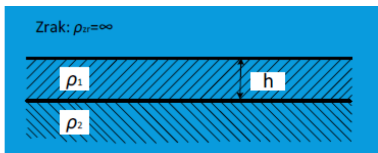
Slika 3.8. Model dvoslojnog tla [3]
