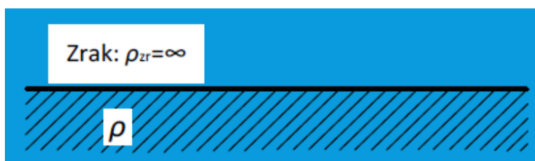
Slika 3.7. Model jednoslojnog tla [3]
