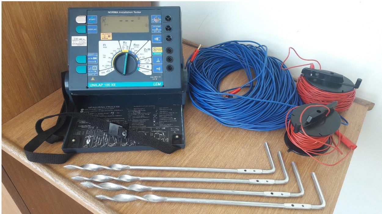
Slika 4.1. Mjerni instrument UNILAP 100 XE
