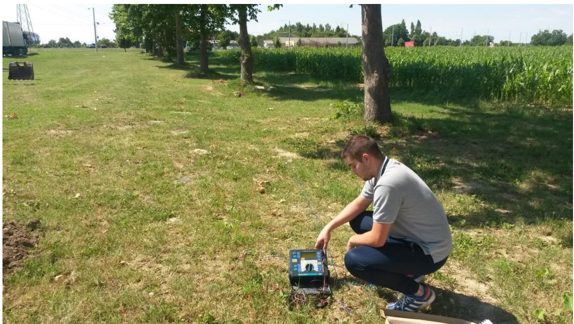
Slika 4.4. Mjerenje otpornosti tla na mekanoj zemlji
