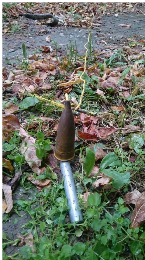
Slika 4.4. Spoj vodiča s mjernom sondom
