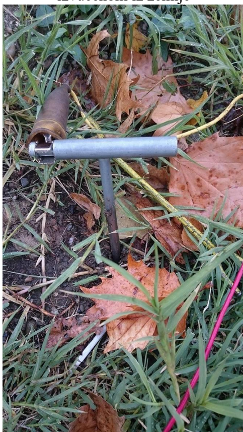
Slika 4.5. Spoj vodiča s mjernom sondom izvučenom iz zemlje
