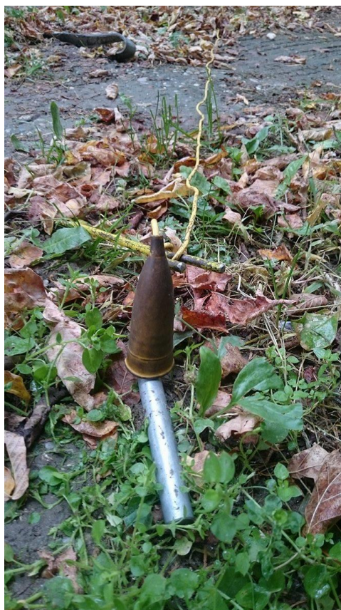
Slika 4.4. Spoj vodiča s mjernom sondom
