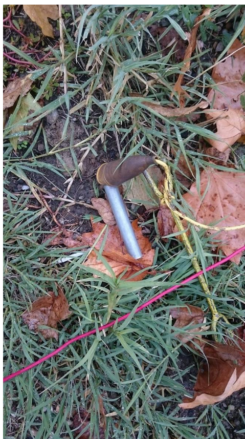
Slika 4.6. Spoj vodiča s mjernom sondom
