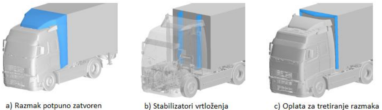
Slika 5.11. Tretiranje razmaka. Izvor [18].
